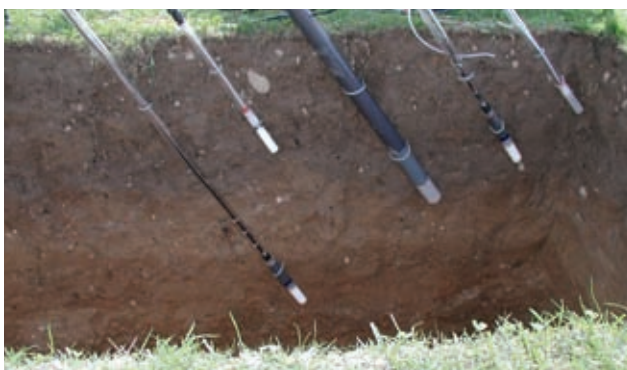
Abbildung 5-21: Einbauprinzip für Wassergehaltssensoren, Tensiometer und Saugsonden
