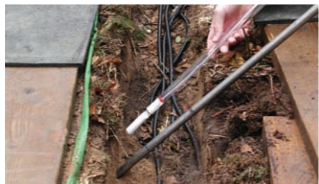
Abbildung 5-22: Einbau einer Saugsonde mit Saugkerze aus Duranglas
