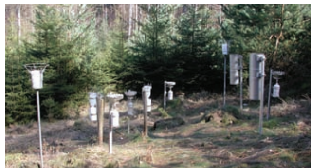
Abbildung 5-11: Freilandmessfläche Wilhelmsfeld mit Depositionssammlern (Bergerhoff-, Trichter-Flasche- (Hauptelemente) und PAK-Sammler von links nach rechts)
