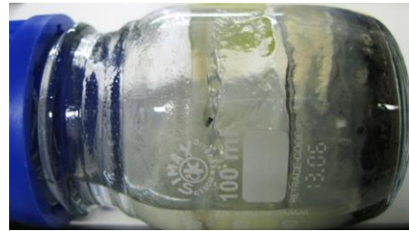
Abbildung 15: Gelieren der Extraktionsflüssigkeit durch Silikatpolymerisierung bei pH Werten unter 2.
