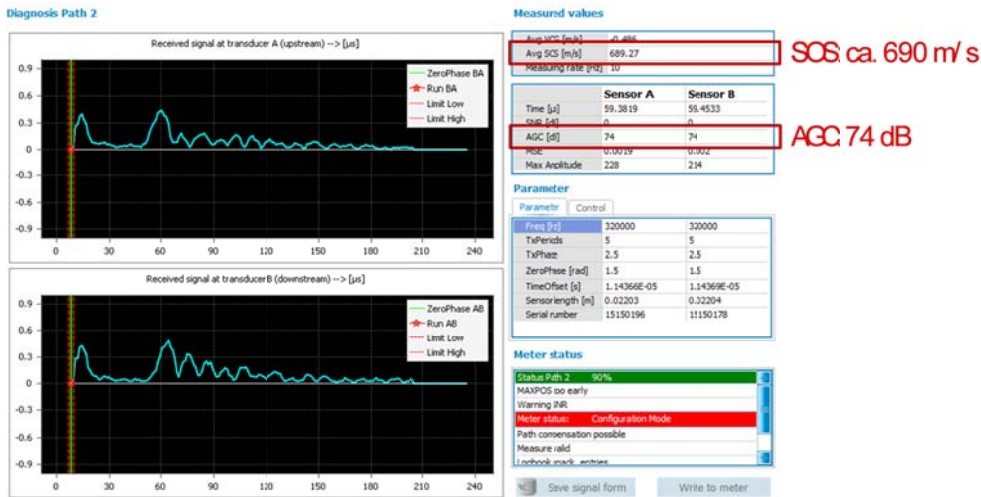
Abb. 54: Zumischung von H 2 : SOS = 690 m/s → AGC ↑↑, Laufzeitdifferenz
