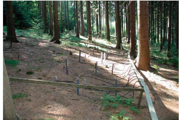
Intensiv-Messfeld Wilhelmsfeld, links Sickerwasser, rechts Bodenphysik
