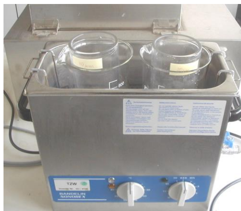
Bild 2.12: Siebung der Fraktionen < 60 \mu\text{m} und < 20 \mu\text{m} im Ultraschallbad
