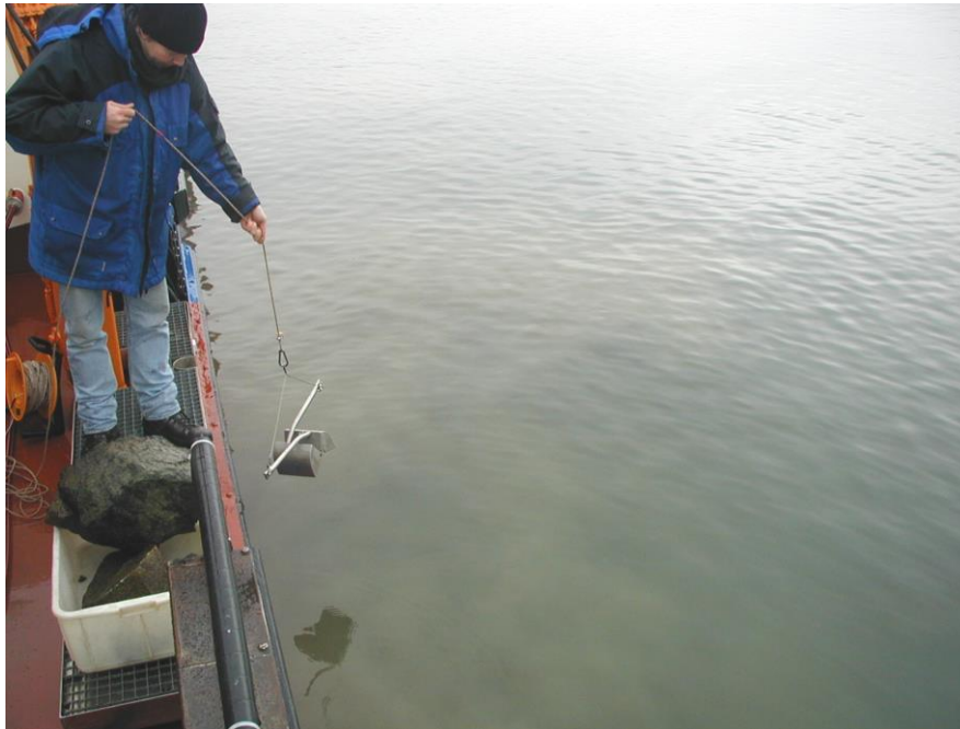
Bild 2.1: Entnahme von Oberflächensediment mittels Handgreifer
