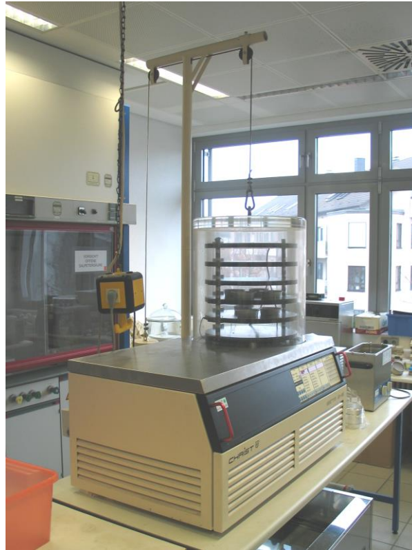
Bild 2.10: Gefriertrocknungseinrichtung BETA 2-16 der Firma Martin Christ Gefriertrocknungsanlagen GmbH, Osterode
