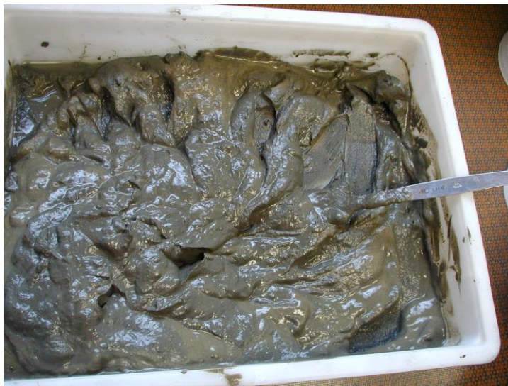
Verrühren der einzelnen Sediment-Teilmengen mittels eines Metalllöffels
