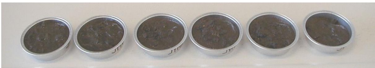
Bild 2.9: Verteilung von feuchten Sedimentproben auf Flachschen aus Aluminium
