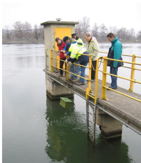
Bild 2.6: Ausbringung einer Schwebstofffalle im Oberrhein
