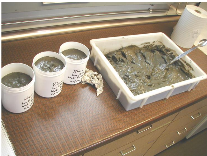
Bild 2.2: Homogenisierung frisch entnommener Rheinsedimente und Verteilung des Materials auf drei Gefäße
