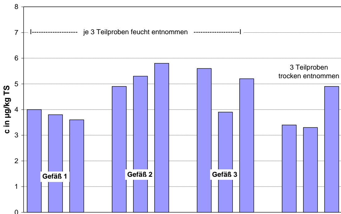
Bild 3.8: Gehalte an PCB153 in Teilproben einer Sedimentprobe aus dem Rhein bei Gamsheim
