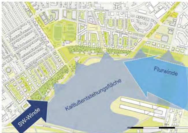
Abbildung 3: Hauptwege lokaler bodennahe Kaltluft in die überhitzten Bebauungsbereiche (Plangrundlage: Studio Wessendorf, ergänzt von KIT).
