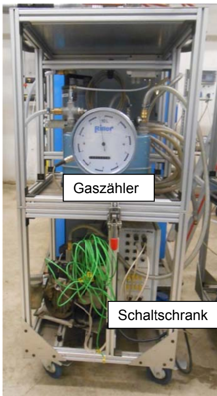
Abbildung 3.5 Staubaufbau (schematisch [Axarlis, 2011] und als Fotos) für die gravimetrische Staubbestimmung nach VDI-Richtlinie 2066 Blatt 1 [2006]
