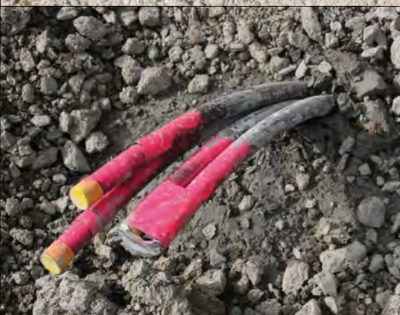
Unteres und oberes Ende einer Doppel-U-Sonde aus Polyethylen Bilder: R. Müller
