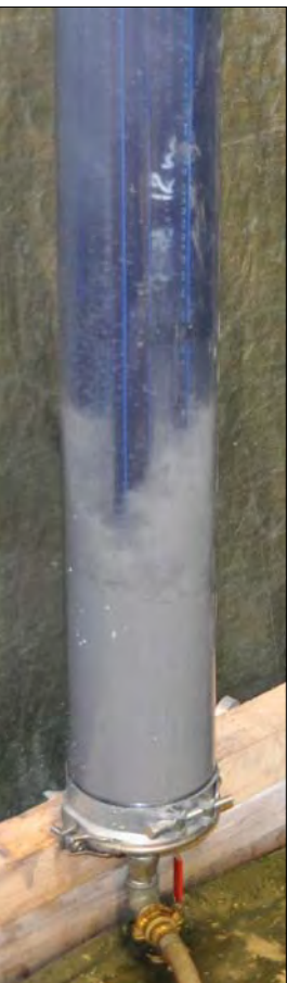
Transparente Röhren dienen dazu, das Verhalten diverser Füllstoffe unter unterschiedlichen Bedingungen im Technikum des KIT zu testen.
