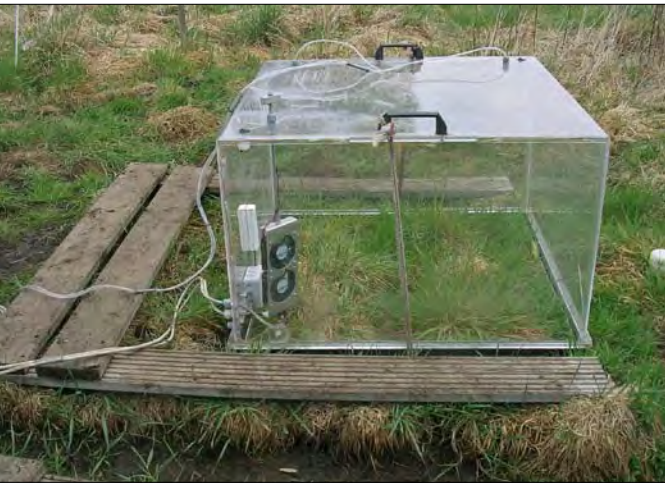
Aus diesen Hauben werden im Untersuchungsgebiet am Oberrhein und im Pfrunger-Burgweiler Ried Gasproben entnommen. Sie können bei höherer Vegetation bis zwei Meter hoch aufgestellt werden.
