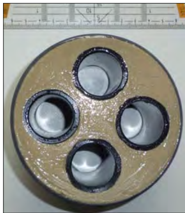
Oben: Querschnitt des Probekörpers. Links: Füllprozess mit einer integrierten Doppel-U-Sonde. Unten: Kleiner Riss im Füllmaterial nach der Aushärtung.
