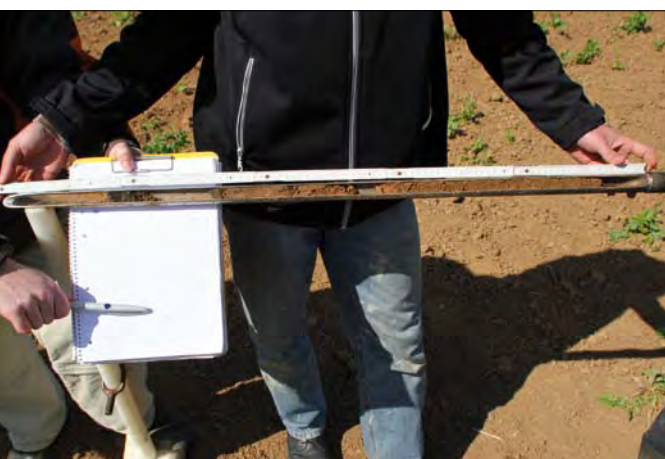
Neben den aufsteigenden Gasen interessiert die Forscher auch, wie es unter der Erdoberfläche aussieht. Dafür werden Bohrkernentnommen und analysiert. Bilder: Universität Mainz
