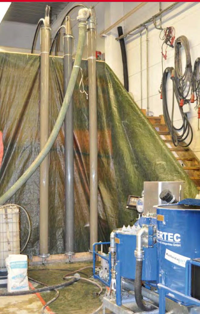
Transparente Röhren dienen dazu, das Verhalten diverser Füllstoffe unter unterschiedlichen Bedingungen im Technikum des KIT zu testen.
