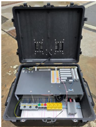
Abbildung 4-5 Mobiler Messdatenkoffer (Innenansicht)
