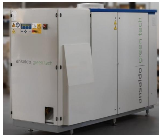
Abbildung 4-2 Gesamtansicht AE-T100 im Gehäuse
