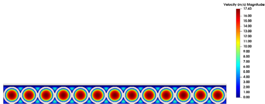
Abbildung 3.2 : Geschwindigkeit Luft am Austritt der Strömungsrohre
