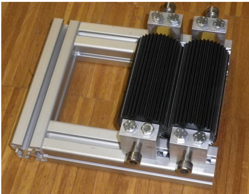
Abbildung 8.1 Vorrichtung zur plastischen Verformung von Trennblechen
