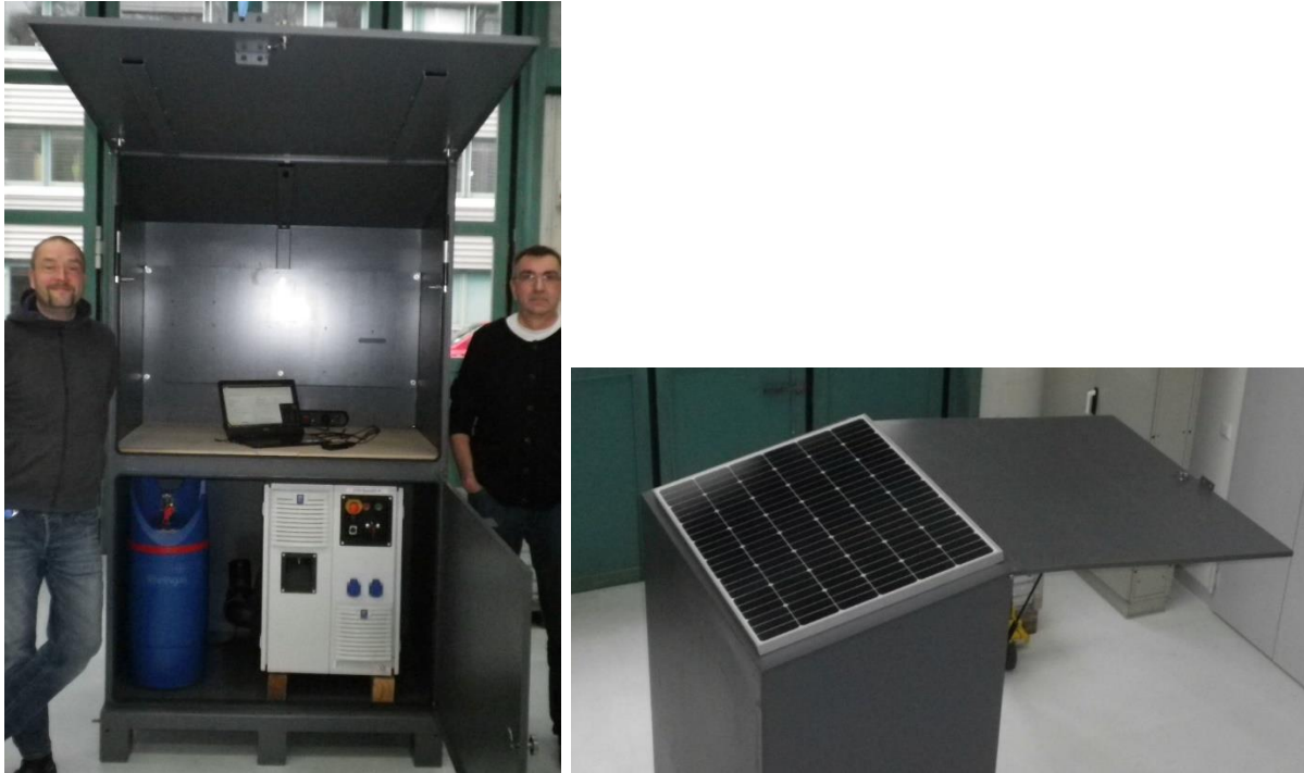
Abbildung 5.4 mobile Werkstatt von IGT mit integriertem BasicBZ-System und PV
