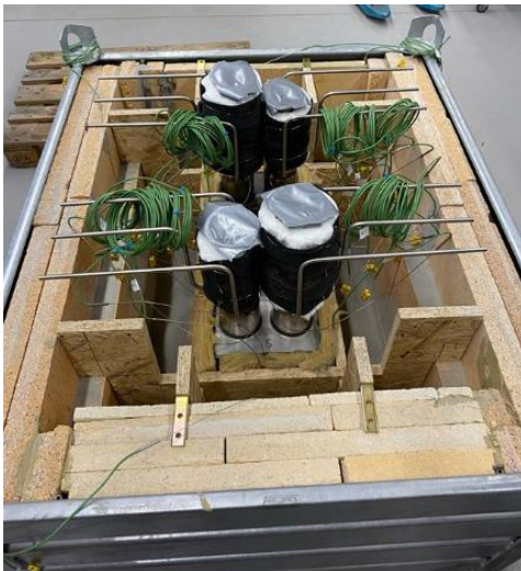
Abbildung 4.7 Verkabelter Wärmetauscher vor Leistungsmessung
