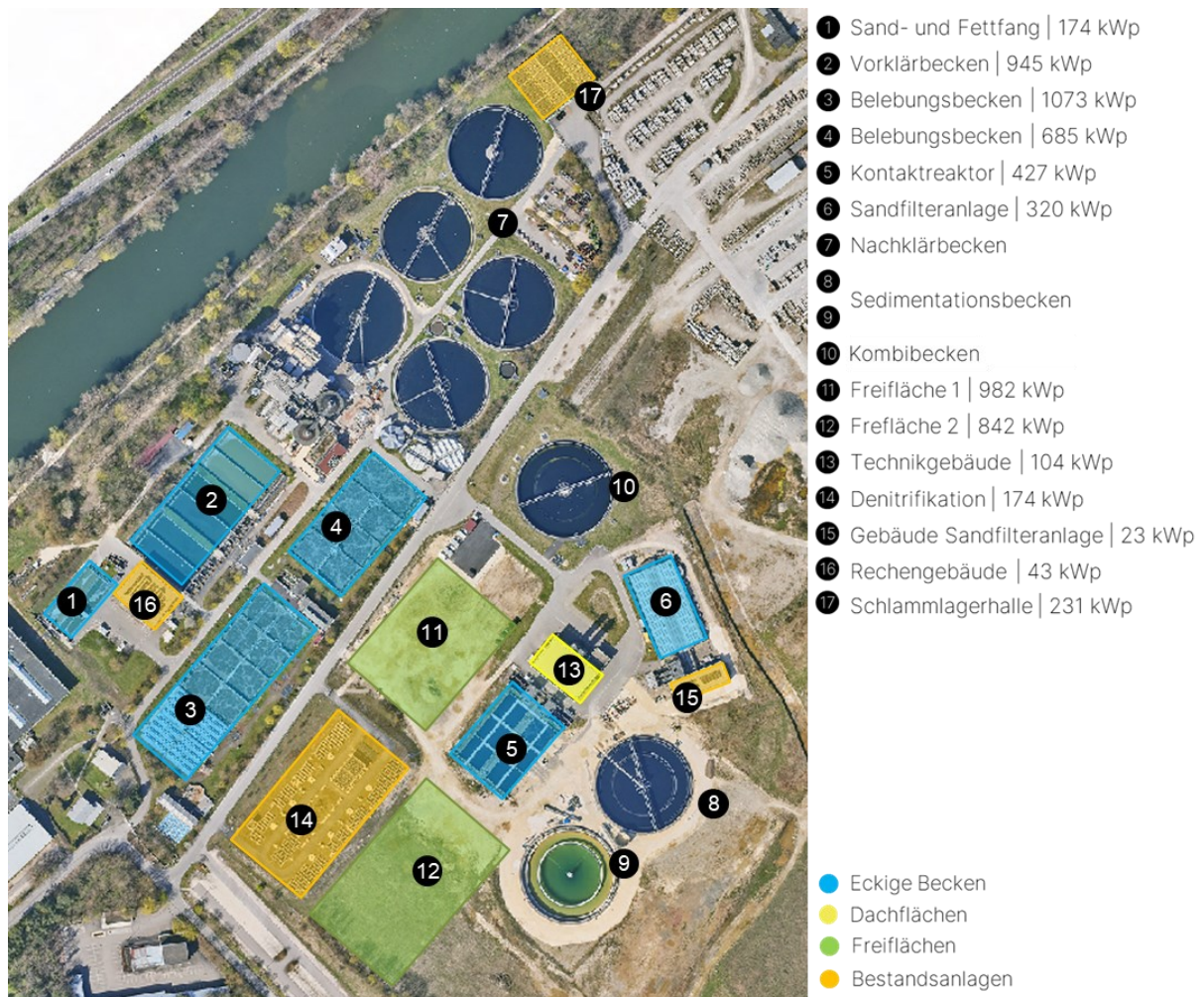
Abbildung 3.3: Darstellung der PV-Bestandsanlagen und potenzielle Erweiterungsflächen auf dem Klärwerk Steinhäule
