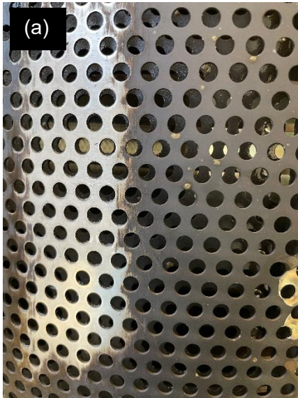
Abbildung AP6 - 5: (a) blanke (links) und belegte (rechts) Kathode, (b) Urin vor und nach der Verwendung im RDBER
