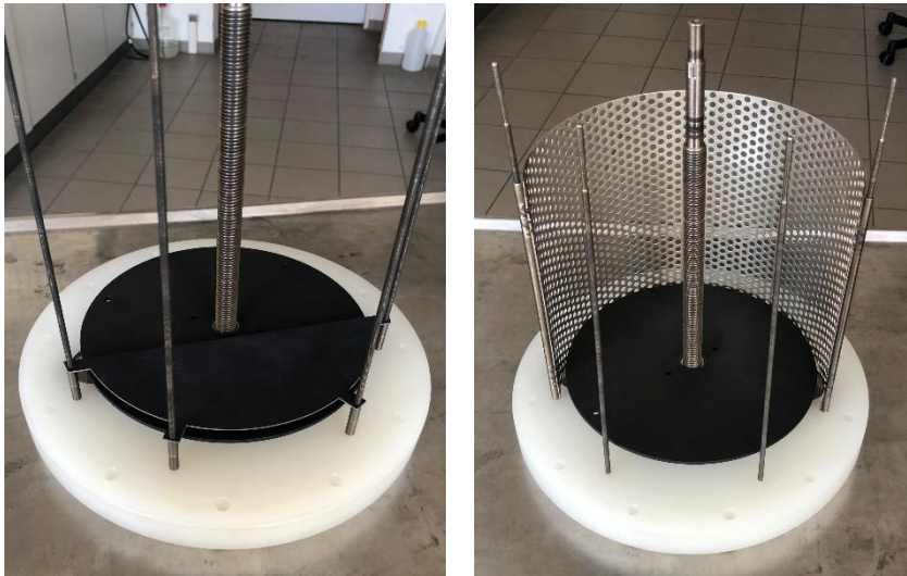
Abbildung AP1 - 6: Kathodenkonfiguration ursprünglich (links, Halbronden) und modifiziert (rechts, Lochblech) am Beispiel des 10 L RDBER
