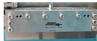
Abbildung 22: Schlitzdüse während des Druckprozesses mit Shim-Breite von 15cm
