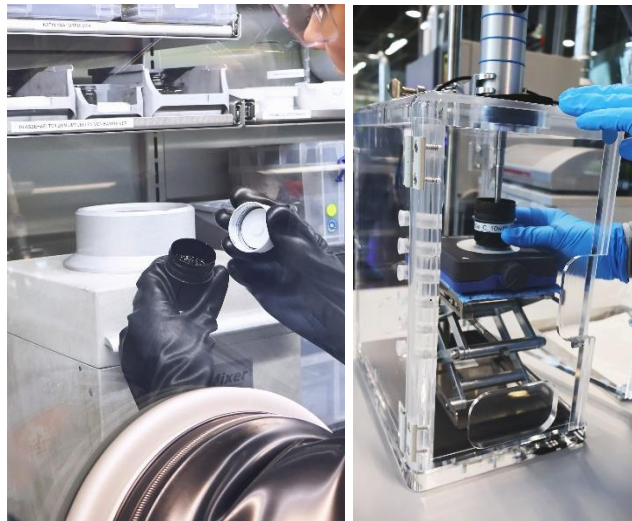
Abbildung 21: Verwendete Geräte zum Mischen und Dispergieren der Anoden und Kathodentinte für Schlitzdüsenbeschichtung. Links: Speedmixer in der Glovebox, Rechts: Ultraschallhorn
