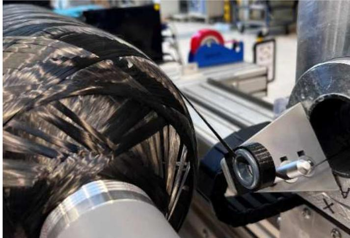
Abbildung 52: Wickelkopf der Wickelanlage beim FIBRE
