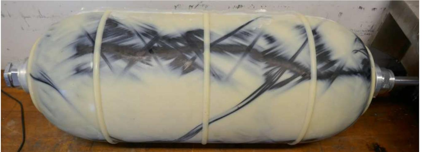
*Abbildung 82: Infiltrierter Prototypentank*
