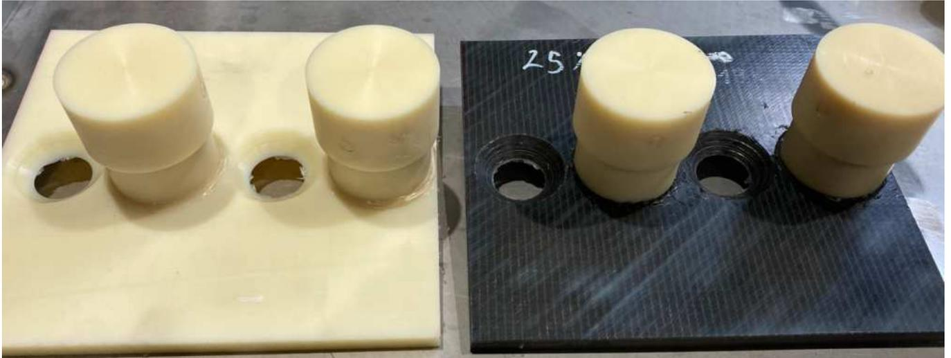
Abbildung 26: reibgeschweißte Platten aus Lauramid bzw. Hicompelt
