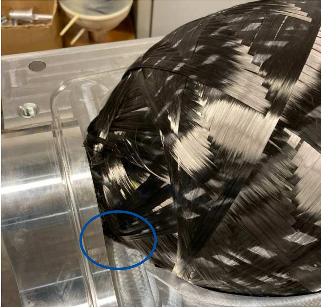
*Abbildung 78: Überstehende Fasern an unterer Formhälfte*
