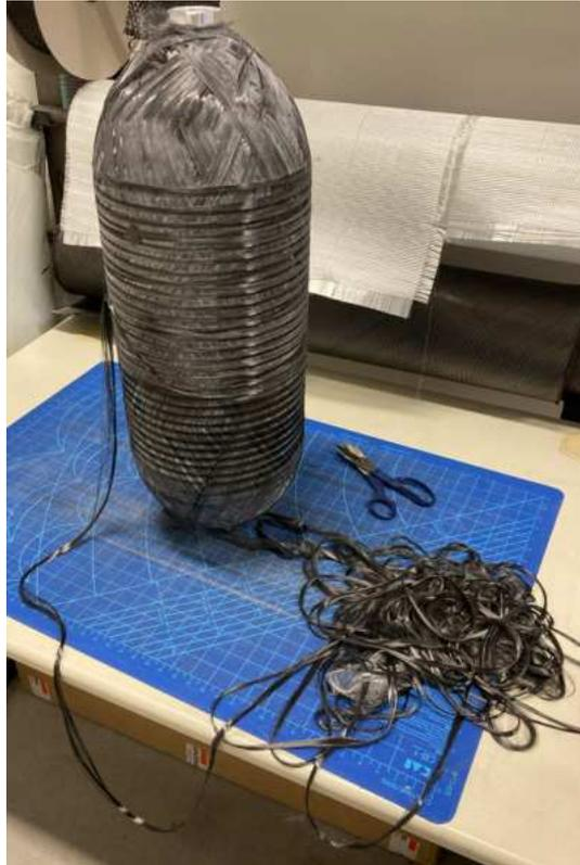
Abbildung 79: Abwickeln der Fasern
