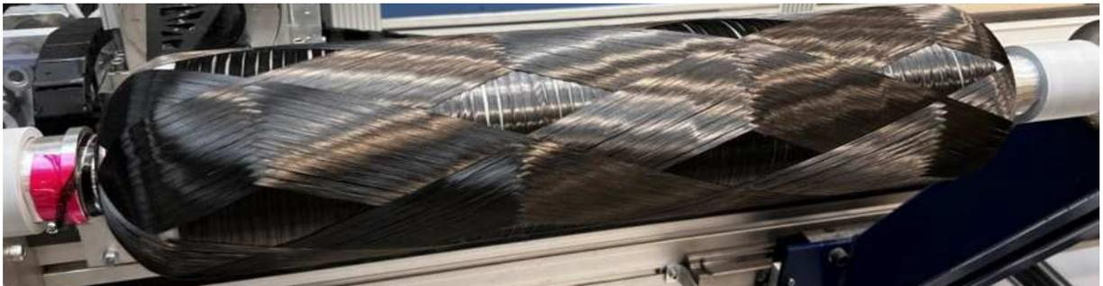
*Abbildung 59: gewickelte Hoop- (89°) und Helical- (21°) Lagen*
