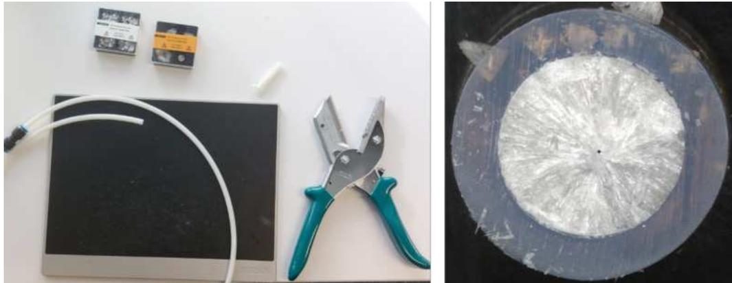
Abbildung 39: Entnahme einer DSC-Probe aus dem PE-Schlauch
