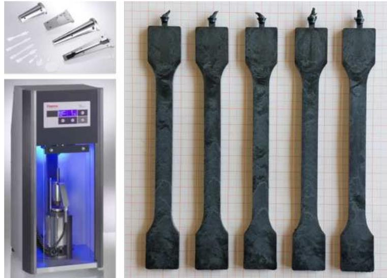
Abbildung 100: v.l. HAAKE™ MiniJet Pro Mini-Spritzgussmaschine, Vielzweckprüfkörper
