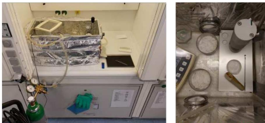
Abbildung 38: Probenpräparation unter Argon
