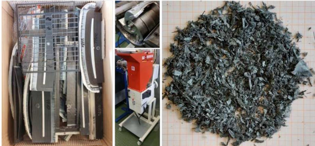
Abbildung 98: v.l. HICOMPELT-Rest, Kunststoffschneidmühle, resultierende Partikelfraktion (Ausgangsmaterial für Folgeversuche)
