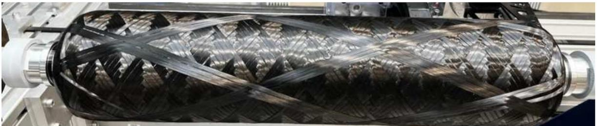
*Abbildung 60: Gewickelte Knuckle- (54°) und Helical- (21°) Lagen*
