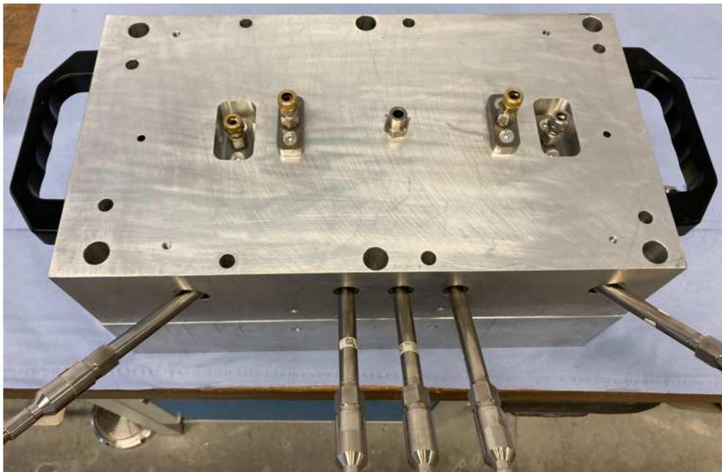
*Abbildung 70: Zusammengebautes RTM-Werkzeug mit 5 Drucksensoren*
