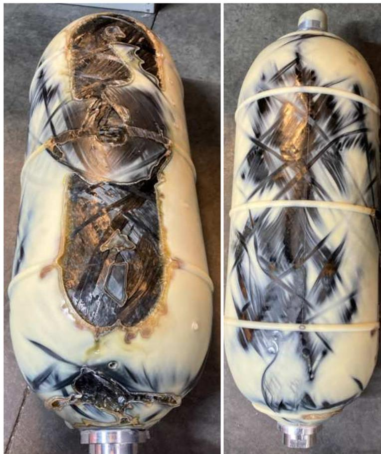
*Abbildung 81: Tankoberseite und Tankunterseite nach Infiltration*
