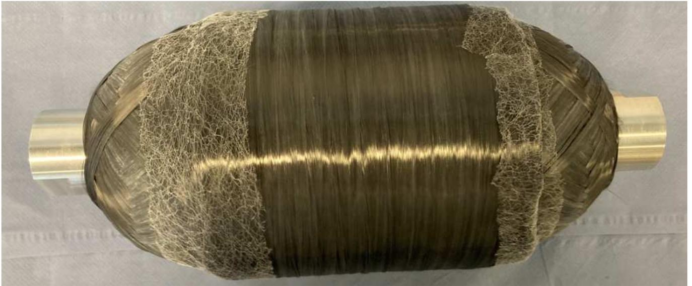
*Abbildung 71: trocken gewickelter Tankpreform*
