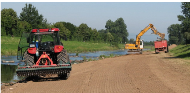
Vorbereiten des Saatbetts mit der Kreiselegge
