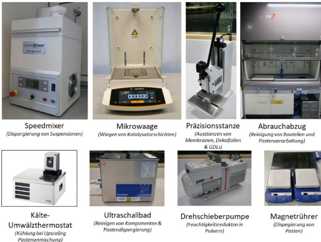
Abbildung 20: Geräte zur Produktion von Katalysatorschichten, welche im Rahmen von HyFaB bereits geliefert und in Betrieb genommen wurden.
