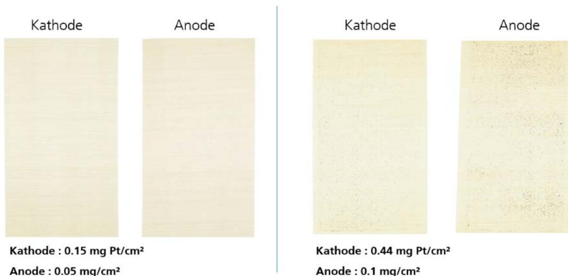
Abbildung 23: Decalfolien nach dem Transferprozess. Bei geringen Beladungen (links) erkennt man kaum Katalysator-Rückstände. Bei höheren Pt-Beladungen (rechts) sind leichte Rückstände erkennbar.
