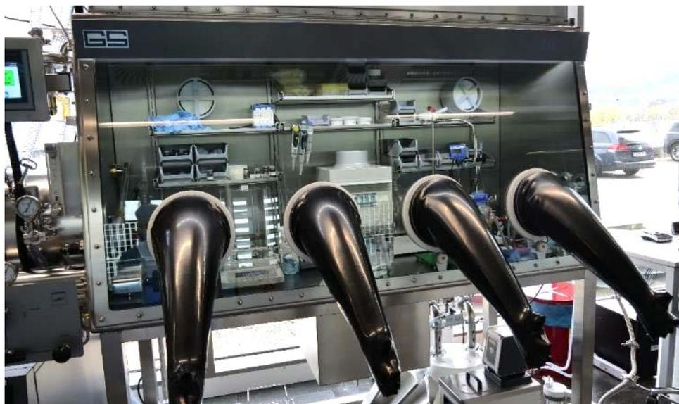
Abbildung 21: Glovebox-System zur Herstellung von Katalysatortinten in einer inerten Atmosphäre
