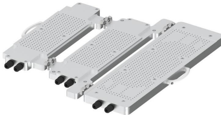
Abbildung 39: Rendering der Stapel- und Ausrichtvorrichtung „Dreifaltigkeit Gasdiffusionslage“
