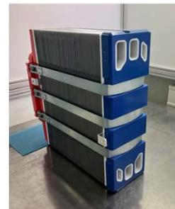
Abbildung 51: Generischer Stack: vom 3D-Rendering zur Realisierung eines 320-zelligen Stacks.
