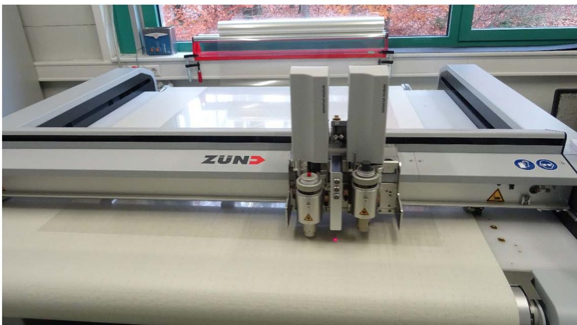
Abbildung 31: Zünd Schneidplotter eingerichtet zum Schnitt von PEN-Randverstärkungsfolien.
