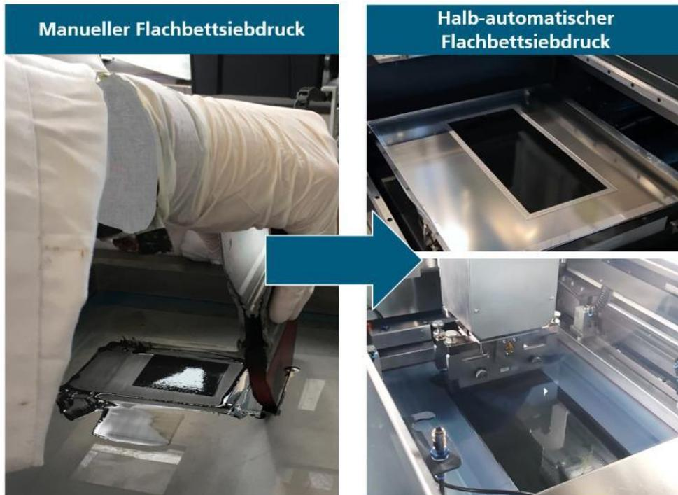
Abbildung 22: Prozessentwicklung während des HyFaB-Projekts beginnend mit manuellem Siebdruckprozess per Hand bis hin zum Ende des Projektes mit der halb-automatischen Herstellung von großflächigen Katalysatorschichten mittels EKRA Siebdruckers.
