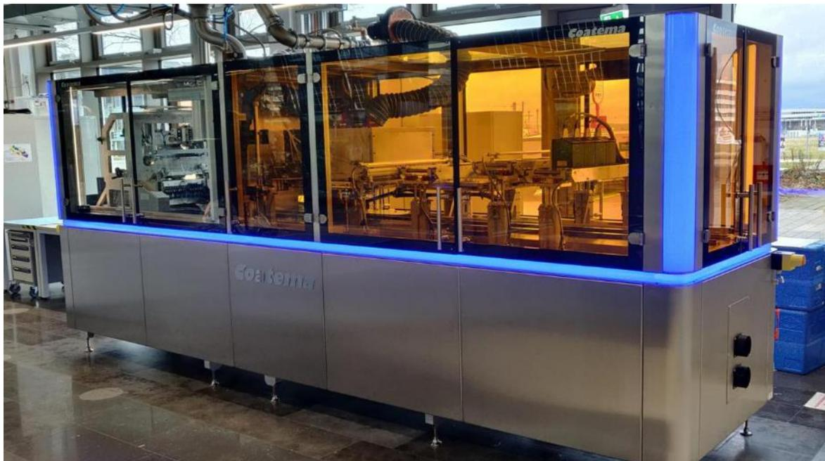
Abbildung 26: Multifunktionalen Druckanlage „EC 80“ von Coatema mit Schlitzdüse, Flexo- und Gravurdruck, sowie inerter Konvektionstrocknung, NIR & UV Trocknung, welche im Rahmen des Projektes beschafft wurde und nun am Fraunhofer ISE im Labor „HyFaB“ steht.
