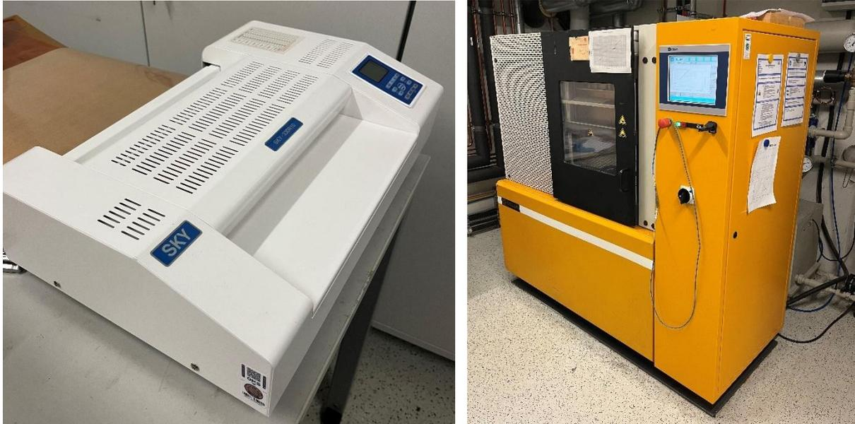
Abbildung 38: Kaltlaminierring (links) und Heißpresse (rechts) des MEA-Fertigungsprozesses
