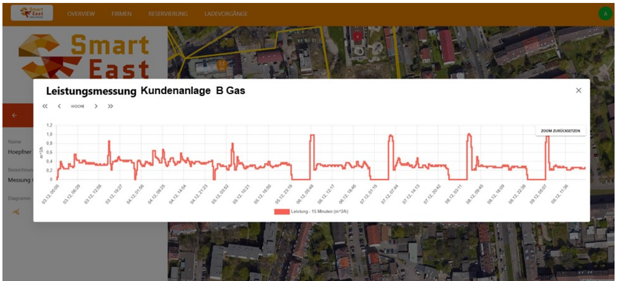
Abbildung 29: Leistungsmessung Gas [m 3 /h] einer Liegenschaft - Wochenlastgang
