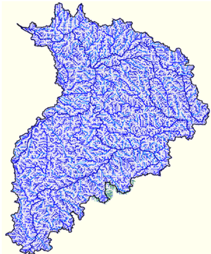
Abb. 1: Vernetzung der Rasterflächen im Wasserhaushaltsmodell Neckar
