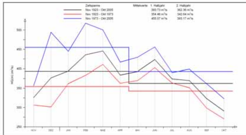
Abb. 3: Pegel Donauwörth/Donau - Ergebnisdarstellung der Analyse des Jahresgangs der monatlichen Höchstwerte HQ(m) und der mittleren halbjährlichen Hochwasserabflüsse MHQ(HJ) für drei unterschiedliche Zeitspannen
