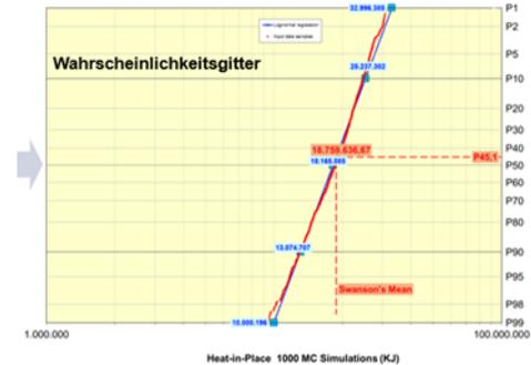
**Abb. 6:** Quantitative Potenzialanalyse. Eine von zahlreichen Möglichkeiten, das geothermische Potenzial in einem Reservoir zu berechnen, ist die Heat-in-Place-Kalkulation nach Agemar *et al.* (2018). Der deterministische Ansatz für einen Zylinder (links) wurde zu dem Monte-Carlo-Simulator KASIMIR weiterentwickelt, welche die Größe Heat-in-Place eines Gesteinskörper als Gauss-Verteilung (Mitte) darstellt. Diese kann zusätzlich in einem Wahrscheinlichkeitsgitter (rechts) dargestellt werden.
