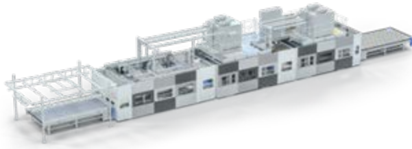
Abb. 16 Rendering der Bürkle Anlage für die Vakuumlamination von Glas-Glas Verbänden (Quelle: Bürkle).
