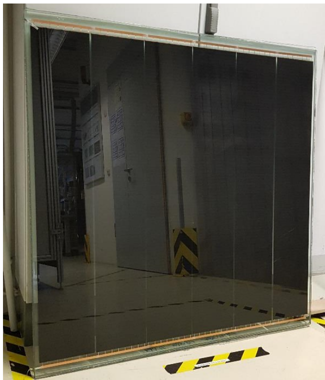
Abb. 7 Im Rahmen des Projekts hergestellter Prototyp eines Glas-Glas PV-Modul mit homogenem Erscheinungsbild, durch geschindelte Solarzellen. Die Solarzellen sind hier noch in vertikalen Strings angeordnet. Für die Matrixverschlaltung werden die Solarzellen zusätzlich in jeder zweiten Reihe um die halbe Breite versetzt, so dass sich die Mauerwerkoptik und elektrische Parallelschlaltung ergibt.
