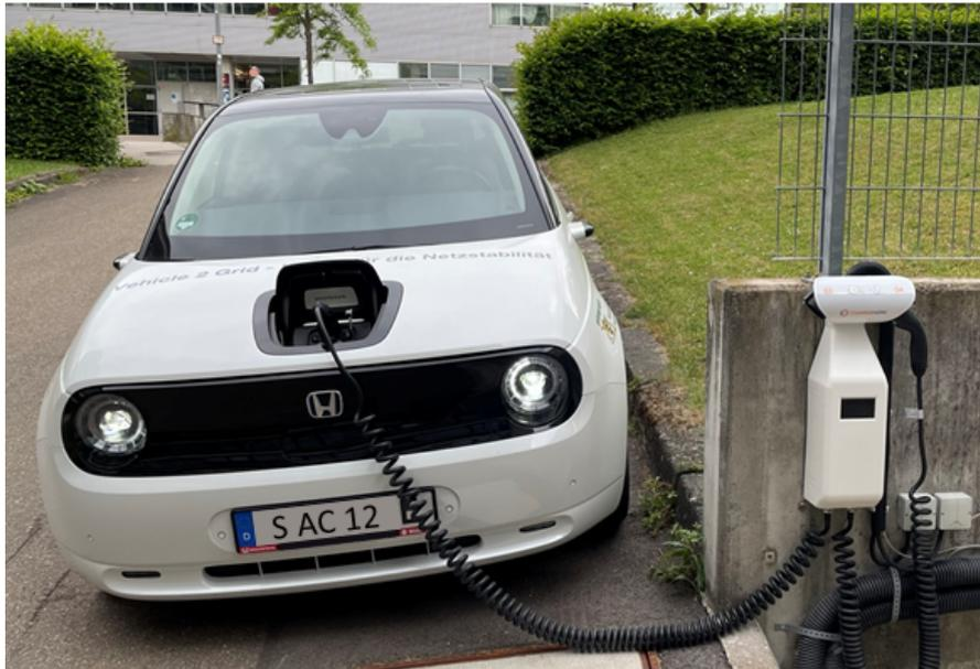
Abbildung 2.23: Elektrofahrzeug beim Ladevorgang am AC-Ladepunkt
