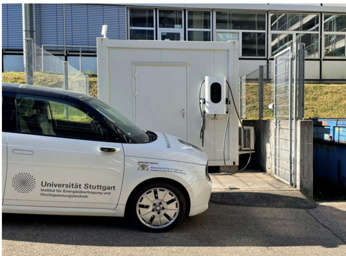
Abbildung 2.21: Smart-Charging-Environment mit bidirektional ladefähigem Elektrofahrzeug und DC-Ladepunkt
