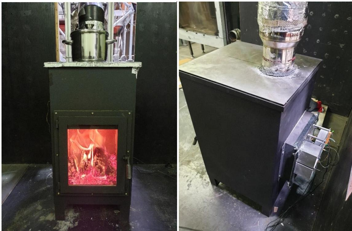
Abbildung 27: Integration der Abbrand-Regelung des Fraunhofer IBP in einen Holzherd gemäß DIN EN 12815 (links: Inbetriebnahme bzw. erste Abbrände in der Versuchsanlage mit Abbrand-Regelung und Funktionstest der Herdplatte; rechts: auf der Rückseite integrierte Grundplatte mit parametrierter Abbrand-Regelung).
