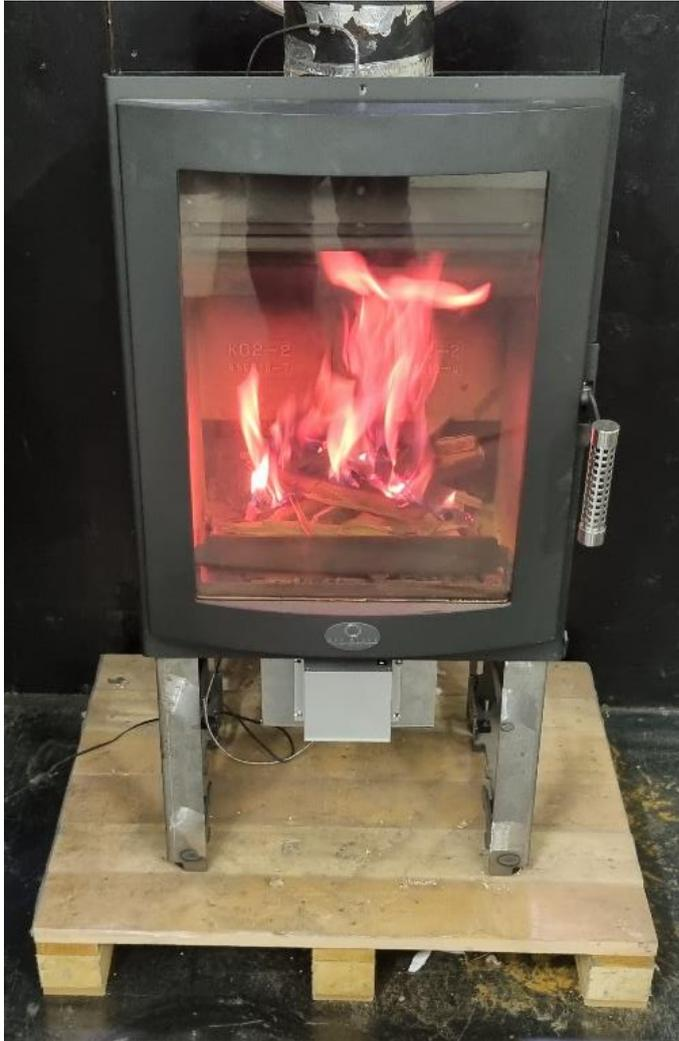
Abbildung 26: Erste Abbrände auf dem Teststand mit integrierter Abbrand-Regelung (Belimo-Version) des Fraunhofer IBP in die Verbrennungsanlage von Max Blank (nur zwei Luftströme).
