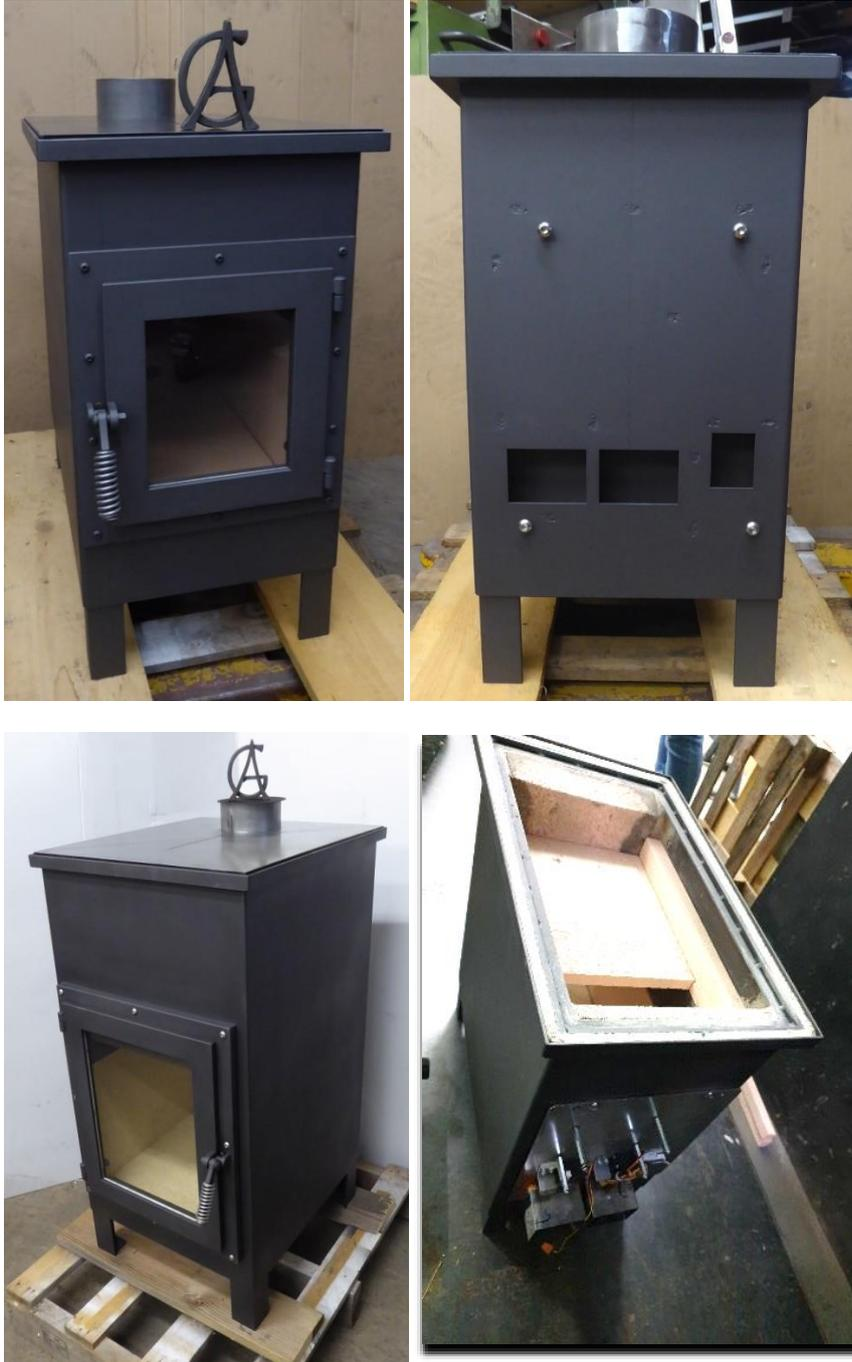
Abbildung 21: Prototypen Holzherd DIN EN 12815.
