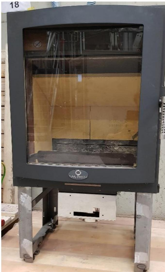
Abbildung 23: Montage der Abbrand-Regelung an den freistehenden Raumheizer nach DIN EN 13240 mit nur zwei Luftströmen.
