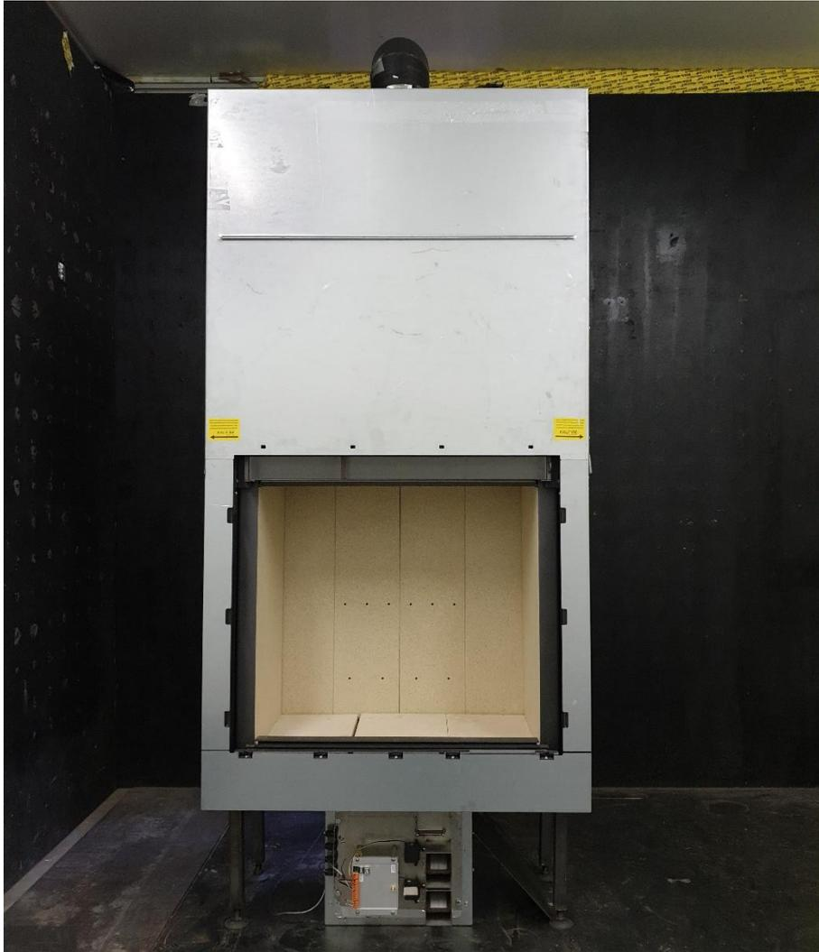
Abbildung 19: Kamineinsatz nach DIN EN 13229 Prototyp 2.0 mit integrierter vertikal angeordneter Abbrand-Regelung des Fraunhofer IBP.
