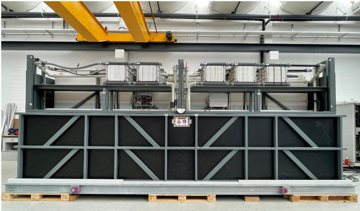
*Abbildung 9: Redox-Flow Batteriespeicher*
