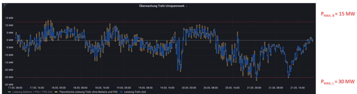
Abbildung 83: Residualleistung an der Übergabestation Hoch- zu Mittelspannung in Haßfurt mit Warnschwellen
