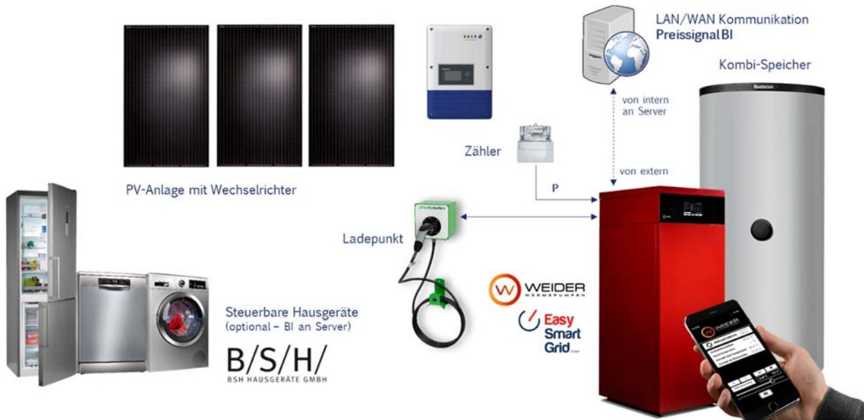
Abbildung 68: Die intelligente Wärmepumpe als Zentrale für die Sektorkopplung im Haushalt
