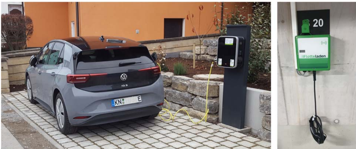
Abbildung 65: Öffentliche Wallbox von ABL (links) und Ladepunkt von Flotteladen (rechts)
