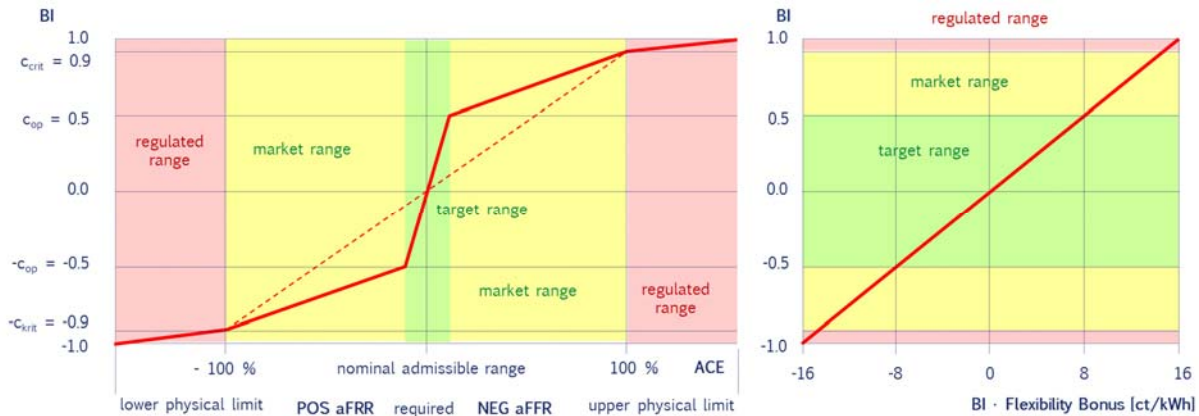
Abbildung 81: Beispielhafte Bildung des Balance Indicator und des Flexibilitätsbonus aus der Regelzonenabweichung (ACE)
