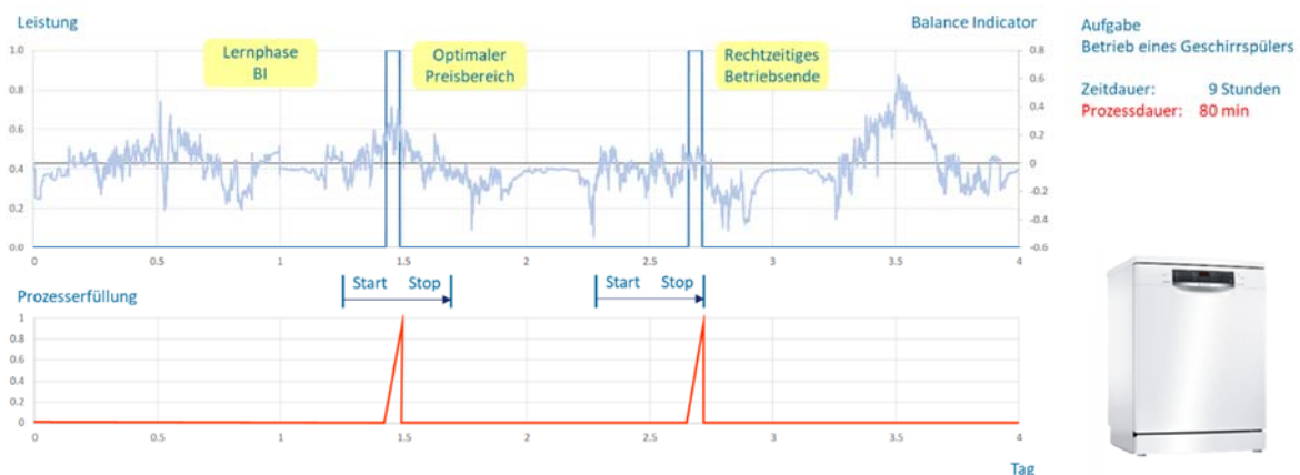
Abbildung 32: Netzdienliche Steuerung einer Geschirrspülmaschine mit dem Balance Indicator
