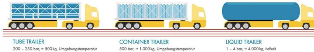
Abbildung 19 Transportmöglichkeiten von Wasserstoff 1
