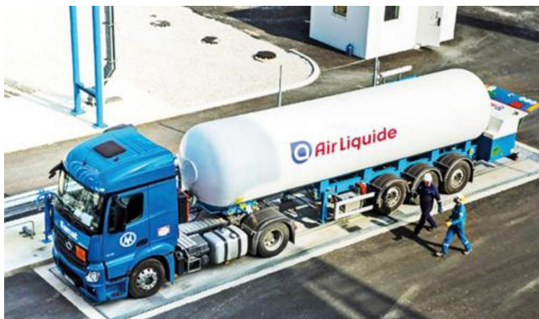
Abb. 12 Trailertank auf Sattelaufleger (Quelle: ASCO CO2-Technologie )
