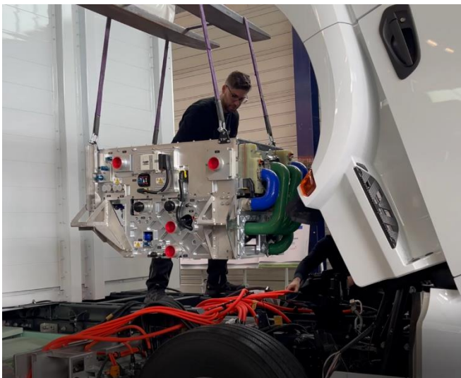
Abbildung 8: Montage der Brennstoffzelle
