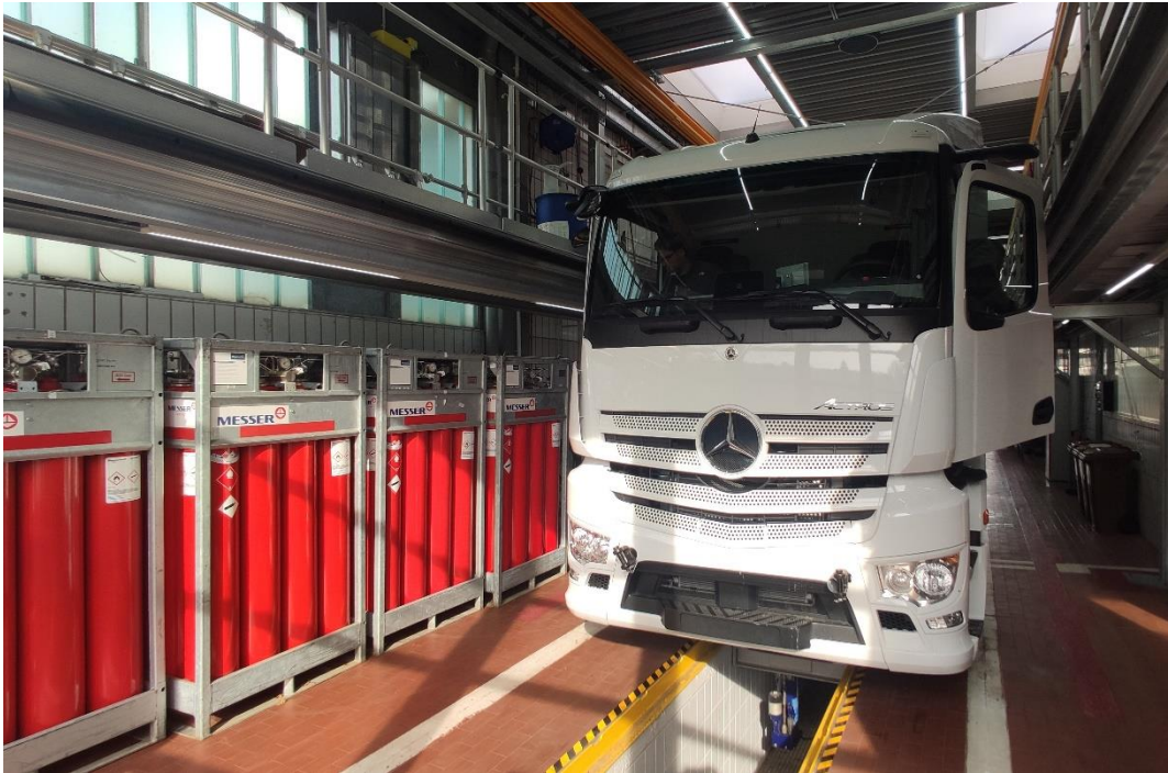
Abbildung 7: Lkw Hylix-B in der Werkstatt der BusWorld Esslingen zur Wasserstoffspülung
