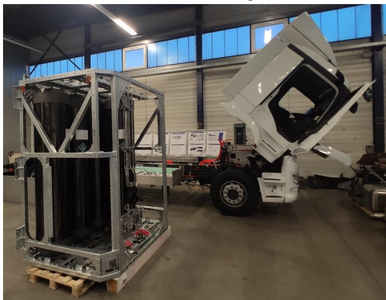
Abbildung 6: Nicht montiertes Wasserstofftanksystem des Lkw Hylux-B
