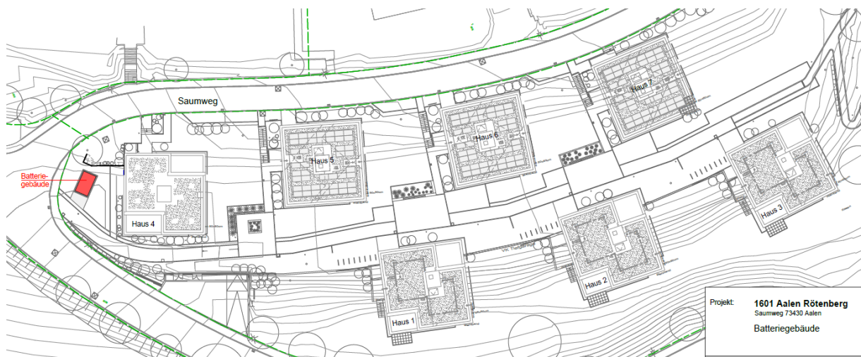
Abbildung 1: Reallabor Aalen Rötberg. Zu erkennen sind die sieben Wohngebäude mit den 71 Wohnungen sowie der Standort des Batteriegebäudes
