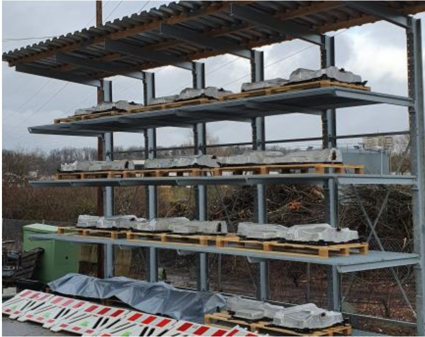
Abbildung 12: Kragarmregal bei den Stadtwerken Aalen zur Lagerung der Batterien. Diese sind im Normalfall durch Planen abgedeckt.
