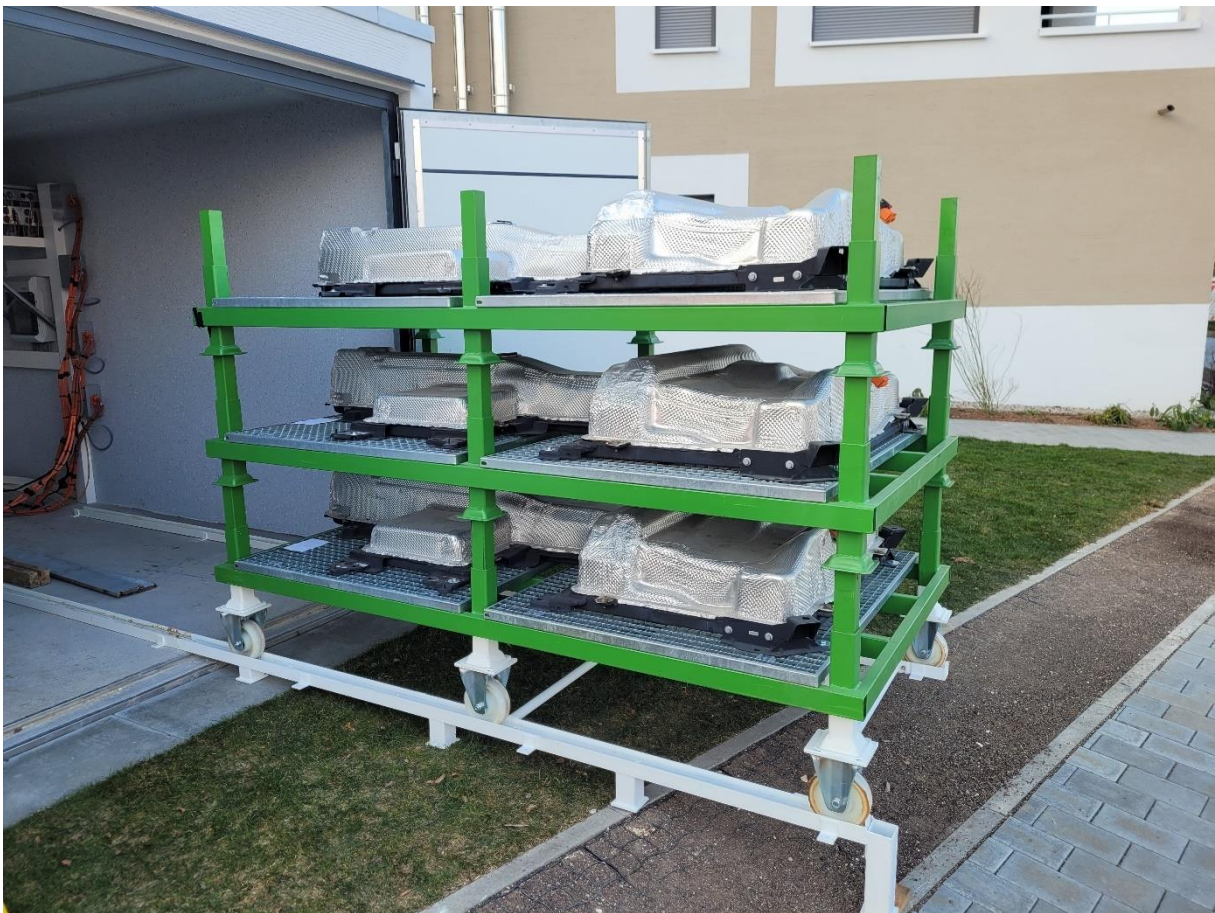
Abbildung 16: Gestapelte Batterien in den Rungenpaletten. Die Batterien können über das Schienensystem ins Gebäude gefahren werden.
