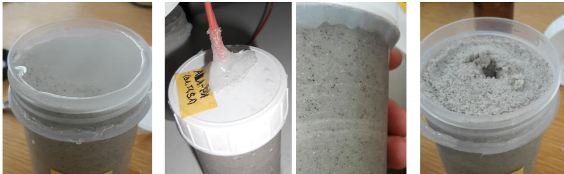
Abbildung 2: Vorbereitung der gesättigten Quarzsandprobe (links), gefertigte Probe mit Silikon versiegelt (Mitte), Öffnung der Probe nach den Versuchen (rechts).
