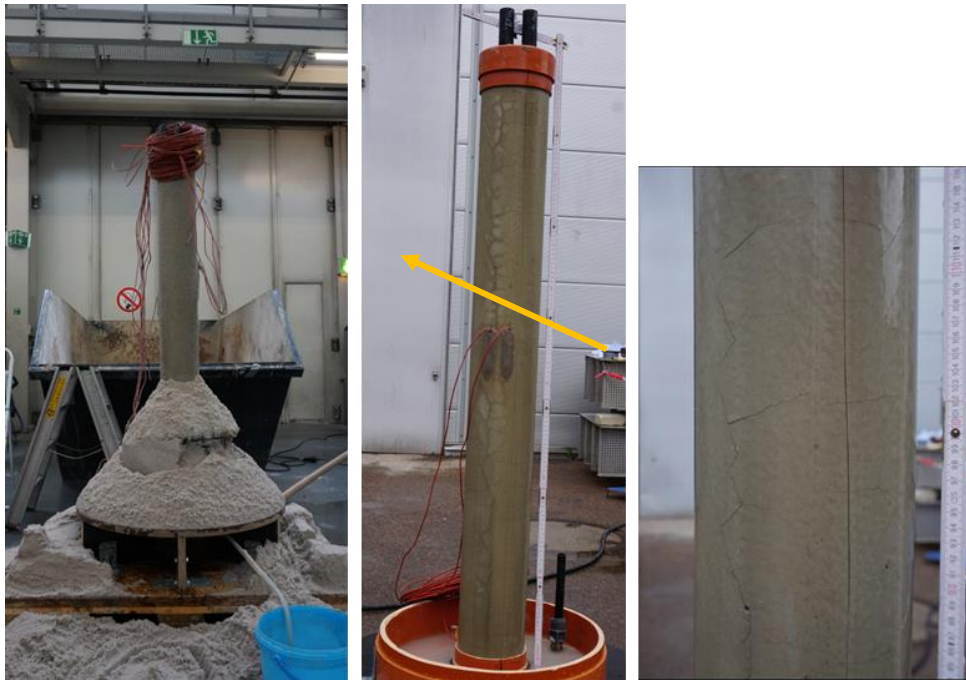
Abbildung 64: visuelle Beobachtung der Konfiguration R5-G2sand nach dem Frost-Experiment
