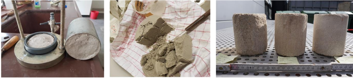
Abbildung 66: Voruntersuchungen des Härteflüssigbodens auf die Kleinskala (IGS, VEGAS)
