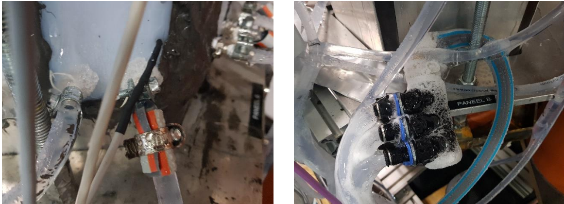
Abbildung 159: Frostentwicklung an der Außenseite
