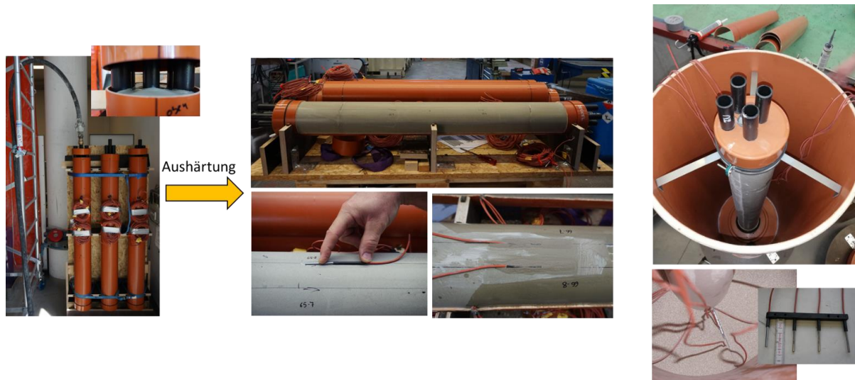
Abbildung 48: Verpressung (links), Einbringung der Außensensoren an die EWS-Rand (Mitte), Befüllung der Versuchsstandsäule (rechts)
