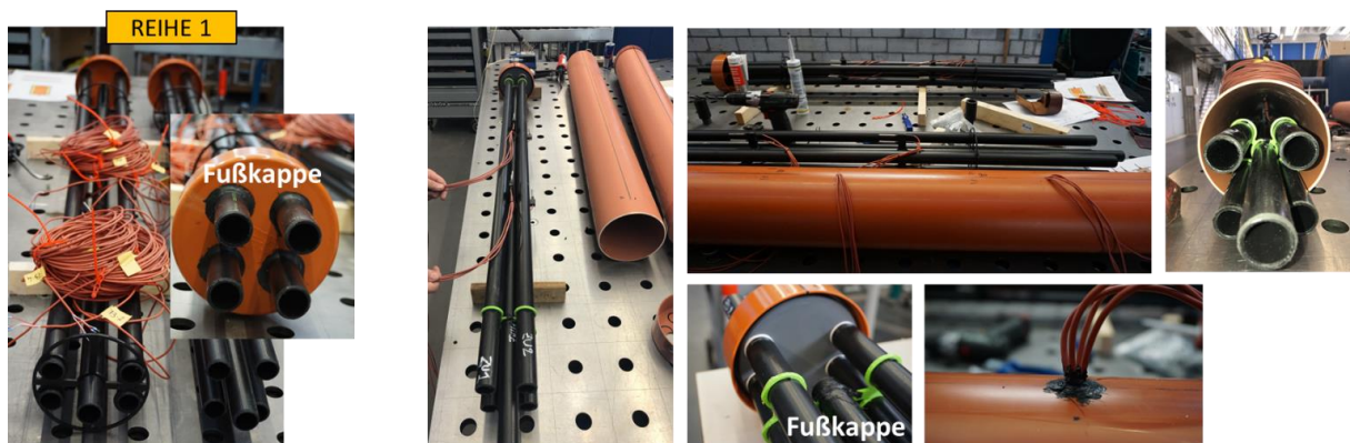
Abbildung 47: Vorbereitung Wärmetauscher im PVC Rohr: Anordnung der Rohre (Geometrie), Einbringung Innensensoren
