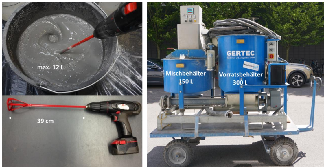
Abbildung 1: Vorbereitung VM2 mittels des kleinen elektrischen Rührer (links) und GERTEC IS-38-E Kolloidmischer (rechts)
