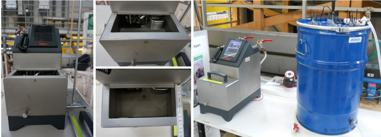
Abbildung 3: Thermostat Ministat 125 links, Thermostatbad in der Mitte, Setup des Thermostats für externe Laboranwendungen (rechts).
