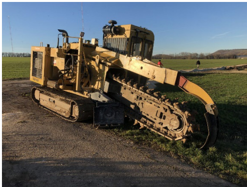
Abbildung 25: Kabelfräse zur Einbringung der Erdkabel in den Kalkstein (Foto: ZSW).
