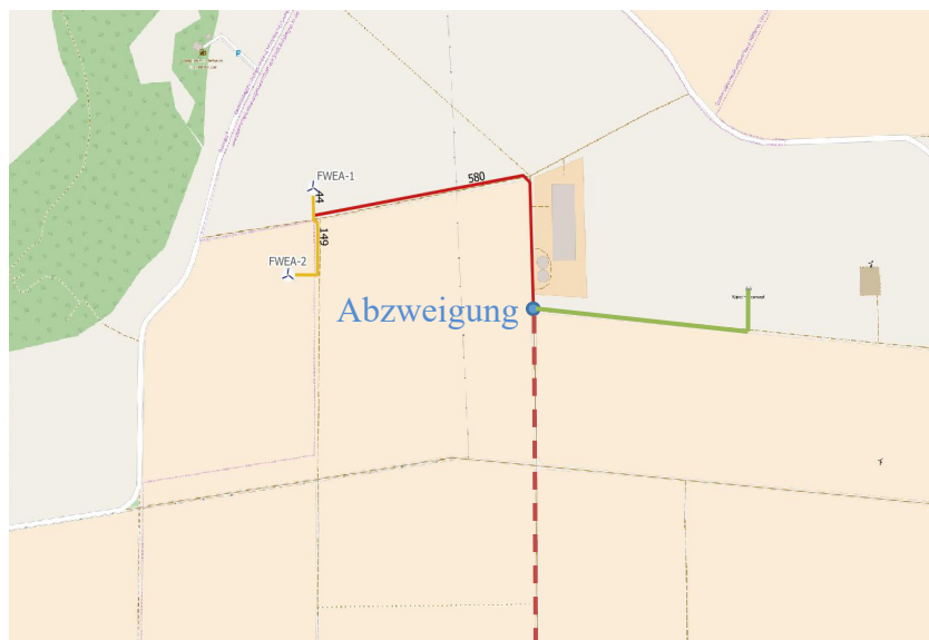
Abbildung 9: Fortführung der Kabeltrasse von der Abzweigung bis zum Testfeldstandort mit den Forschungsanlagen FWEA (blaue Rotoren). Rot gestrichelt ist jener Abschnitt der erworbenen Leitungstrasse, grün ist der Teil der ehemaligen Trassenführung, der nahe Abbau der Bestandsanlage stillgelegt wird (Quelle: ZSW).
