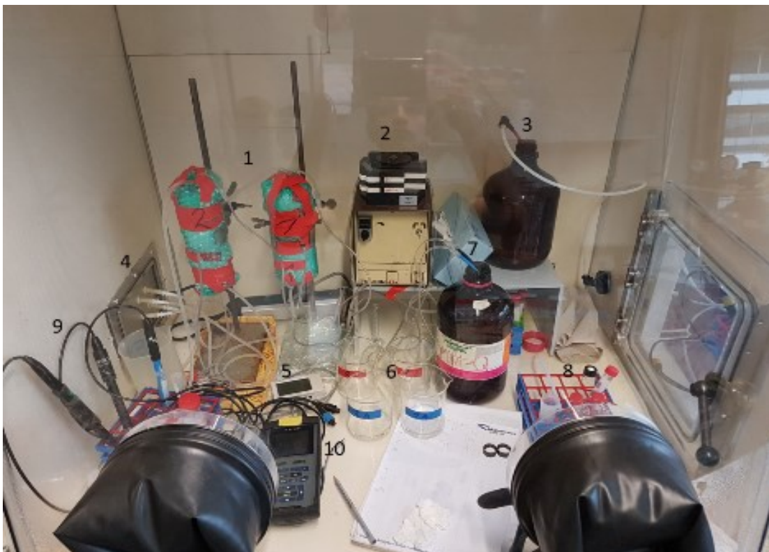
Abb. 6: Aufbau der Säulenversuche mit Sedimentmaterial vom Standort Hockenheim in der Glove-Box im Labor: (1) Säulen, (2) Pumpe.
