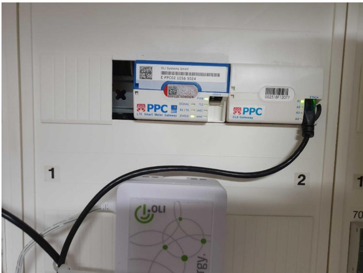
Abbildung 22 Die OLI Box in Verbindung mit PPC SMGW und CLS-GW im derzeitigen BMIL Labor
