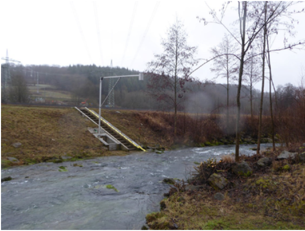
Abbildung 9.2: HRB Kirnau-Adelsheim – Wasserstandsmessung im Unterwasser [LRA Neckar-Odenwald-Kreis]
