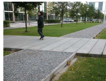
Die Wiesenflächen im Gewerbepark dienen als Sickerflächen und liegen tiefer als die Wege.
