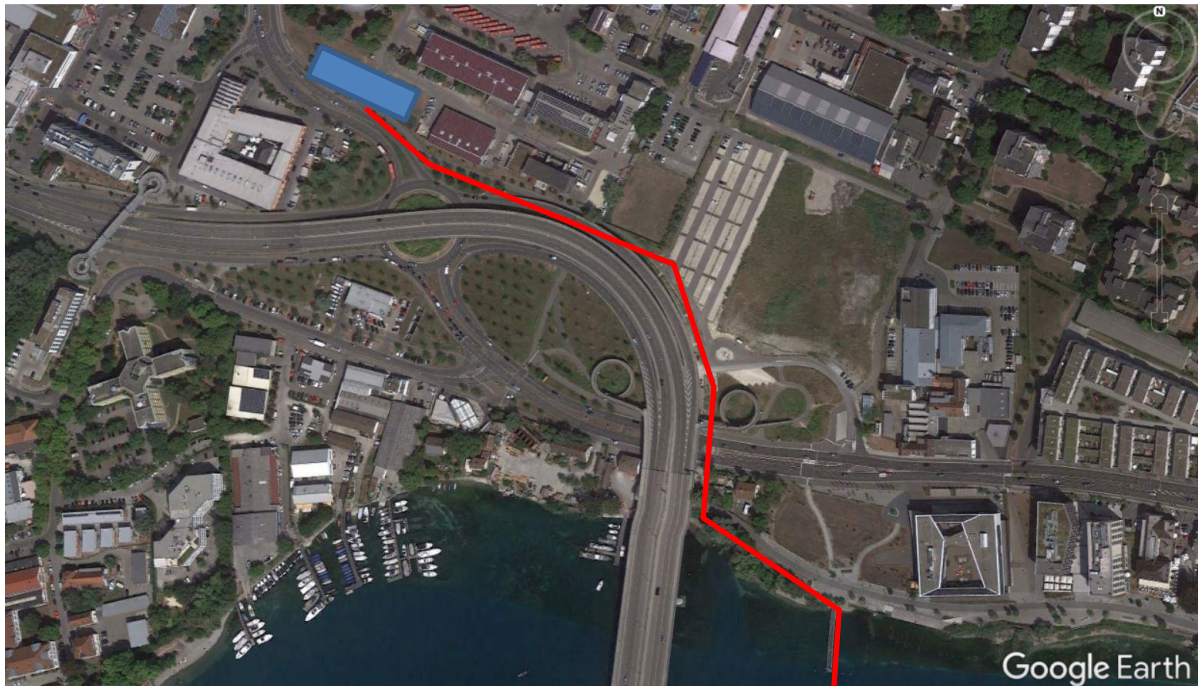
Abbildung 103: Mögliche Führung der Wasserstoffleitung für die Betankung der Schiffe am Bodenseeforum. Die blaue Markierung zeigt den möglichen Standort der Wasserstofftankstelle für Busse auf dem Betriebsgelände der Stadtwerke Konstanz. 146
