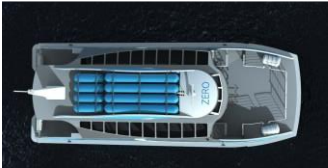
Abbildung 143: Die Sicht auf den Katamaran von oben auf die Wasserstofftanks 241
