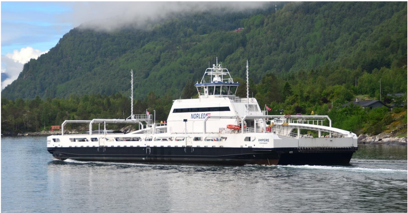
Abbildung 69: Die vollständig elektrische Fähre "Ampere" befährt die sechs Kilometer lange Route E39 zwischen Lavik und Oppedal nördlich von Bergen in Norwegen. Sie fährt im 20-Minuten-Takt 34 Mal am Tag rein elektrisch über den Sognefjord. 112
