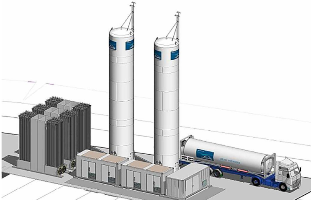
Abbildung 20: Skizze einer Flüssiggas-Wasserstofftankstelle 39
