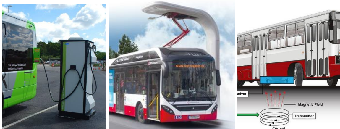
Abbildung 34 Depot-Ladestation 4 (links), Laden über Pantographen 5 (Mitte), kabelloses Laden 6 (rechts)
