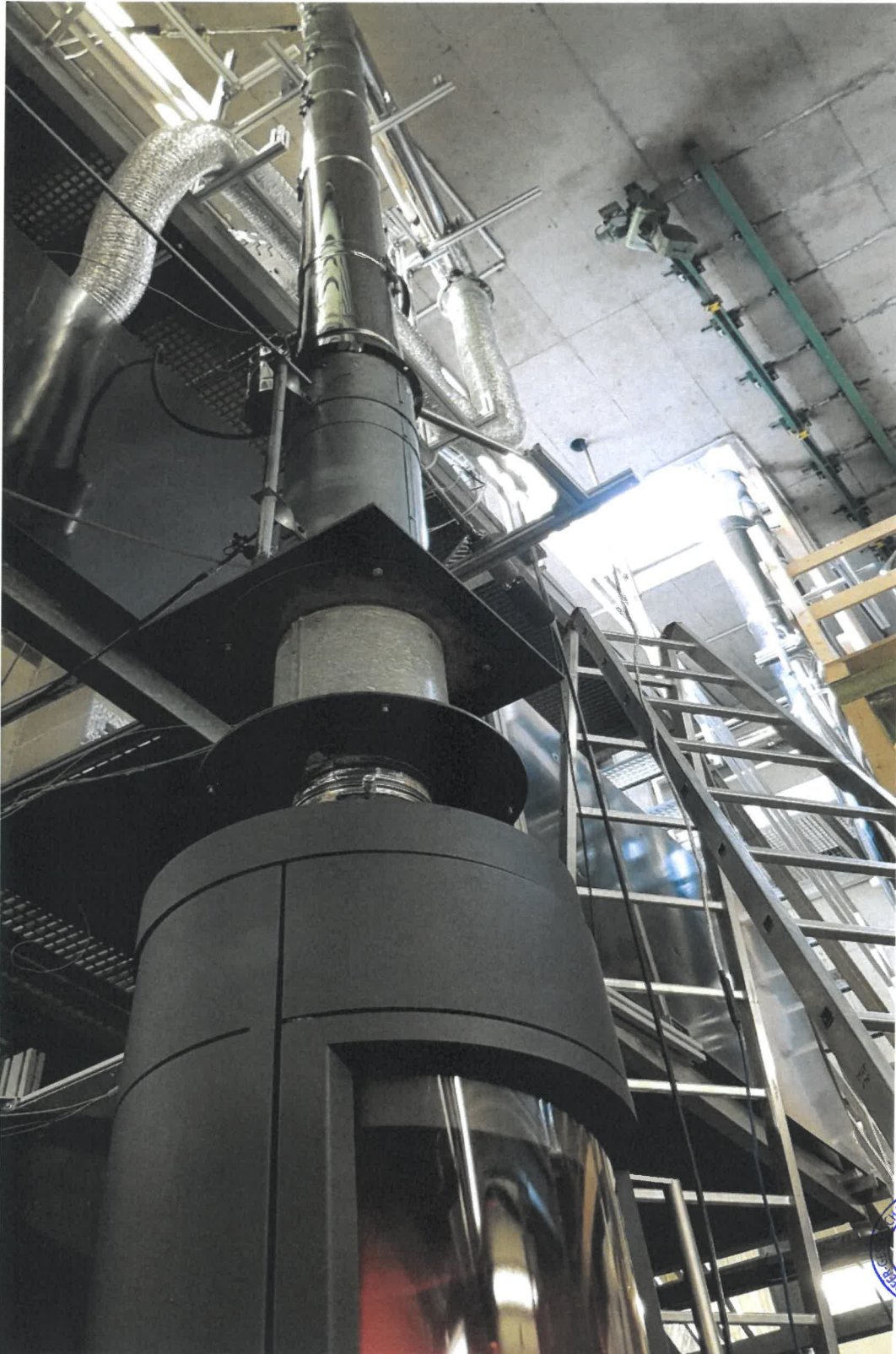
Abbildung 2: Versuchsstand bzw. Prüfstands Aufbau gemäß den normativen Anforderungen im Technikum des Fraunhofer-Instituts für Bauphysik IBP und Installation der modifizierten Versuchsanlage.
