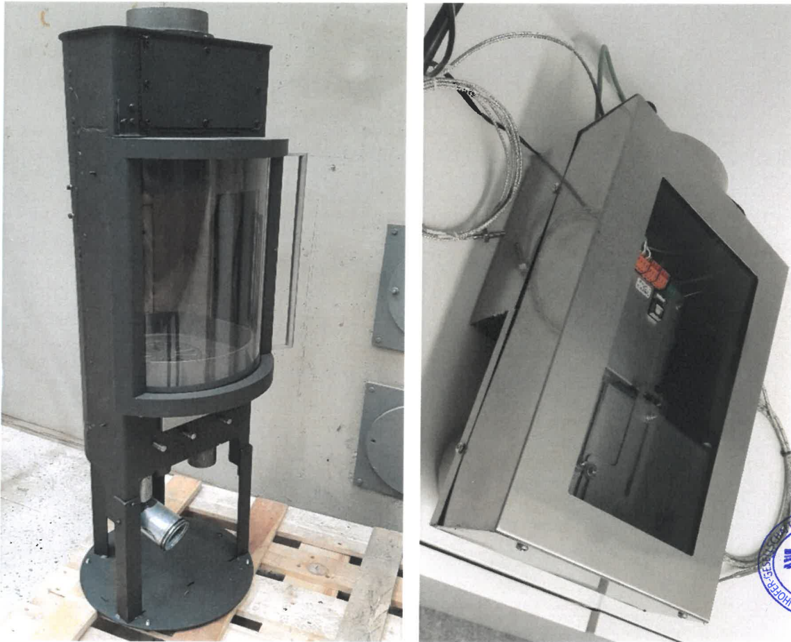
Abbildung 1: links: Modifizierte Versuchsanlage gemäß DIN EN 13240 für den Anschluss der T to O 2 -Regelung; rechts: Verbrennungsluftverteilungsbox mit den Stellmotoren und den Luftschiebern zur Einstellung der Primär und Sekundärluftmengen.
