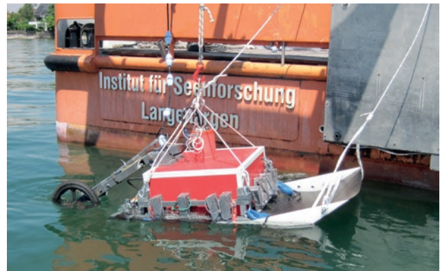
Abb. 5-12: Der Prototyp des Unterwassergeoradars. Die 200 MHz-Antenne befindet sich in dem druckdichten roten Gehäuse, an dem zur Kompensation des Auftriebs insgesamt ca. 200 g Blei angebracht werden mussten. Das Gerät wird an dem Seil an der rechten Seite hinter einem kleineren Schiff oder Boot gezogen, Datenausgang und Eingang für ein an der Oberfläche mitgeschlepptes GPS sind in dem Zylinder auf der Antenne angebracht. (Foto: LUBW, M. Wessels).
