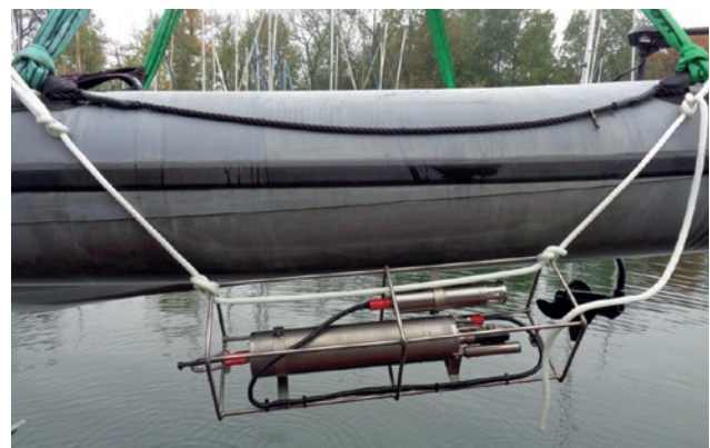
Abb. 5-18: Schlauchboot mit seitlich angebrachter CTD-Multiparametersonde.
