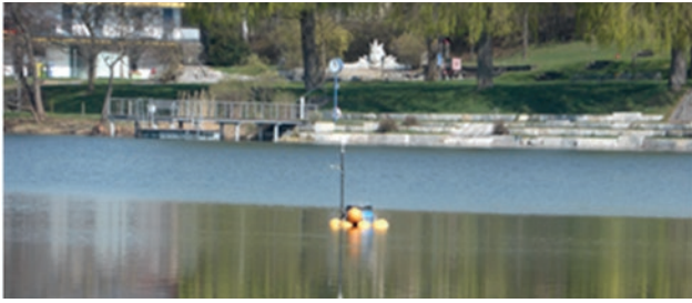
Abb. 5-9: Kontinuierlich messende seenphysikalische Monitoringstation im Steißlinger See.
