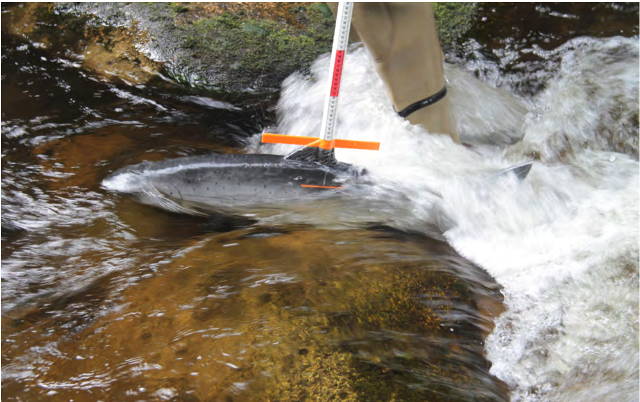
Abbildung 3-1: Prüfung der ausreichenden Wassertiefe an einer pessimalen Schnelle mithilfe eines Bemessungsfisches, hier Lachs
