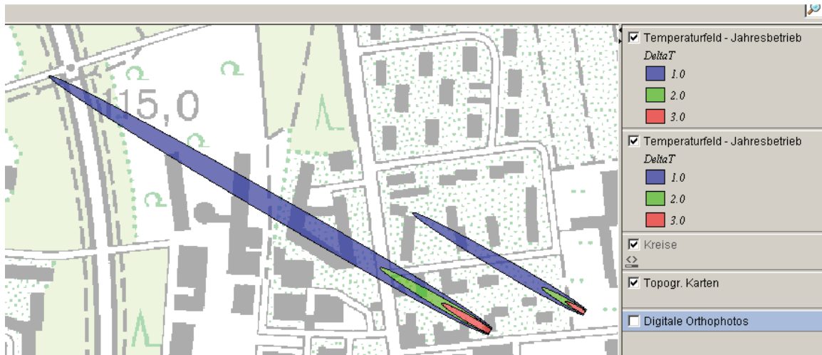
Abbildung 2: Mit der Fachanwendung Grundwasser berechnete Temperaturfelder
