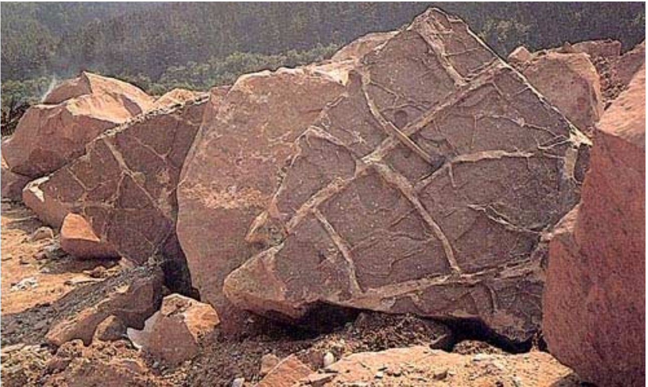
Abb. 9: Blöcke aus dem Mittleren Buntsandstein (sm 1) mit Trockenrissen, Tunnelausbau E Hirschhorn. Größe des Blocks: 1,2 x 1,8 m. Foto SCHÖTTLE
