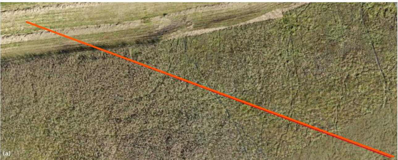
Abb. 3.3-4: Profilschnitt vom Hochmoorbereich in einem dicht mit Binsengras bewachsenen Bereich. Das DGM_10cm dürfte überwiegend die Grashöhe wiedergeben, die Geländeoberfläche wird nur vereinzelt erreicht.
