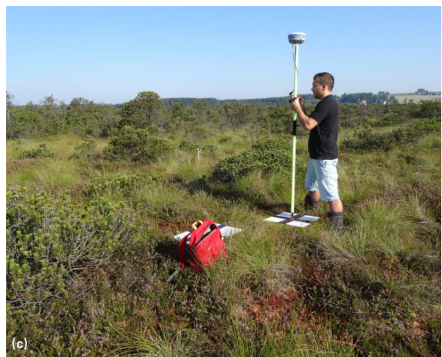
Abb. 2-1: Aufnahmen während der Befliegung. (a) Hexacopter des Typs XR6 (Drohne). (b) Das Drohnen-System im Wurzacher Ried im Einsatz. (c) Auslegung und Einmessung von Platten mit Koordinatenkreuz als Referenzpunkte für die Georeferenzierung des Luftbilds.
