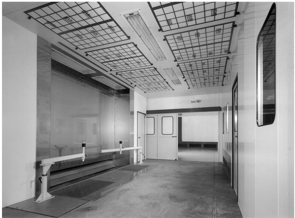
Bild 6: Aufnahme einer automatischen Spritzlackieranlage mit Hängeförderer (Quelle Fa. Rippert).
