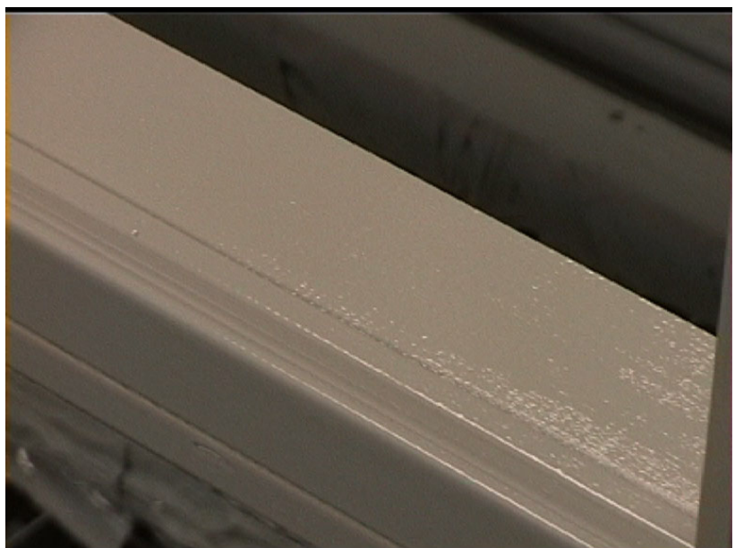
Bild 24: Nasse Lackschicht auf einem soeben lackierten Holzwerkstück
