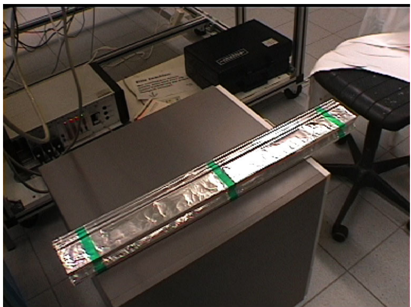
Bild 22: Werkstück, formschlüssig in Aluminiumfolie eingepackt
