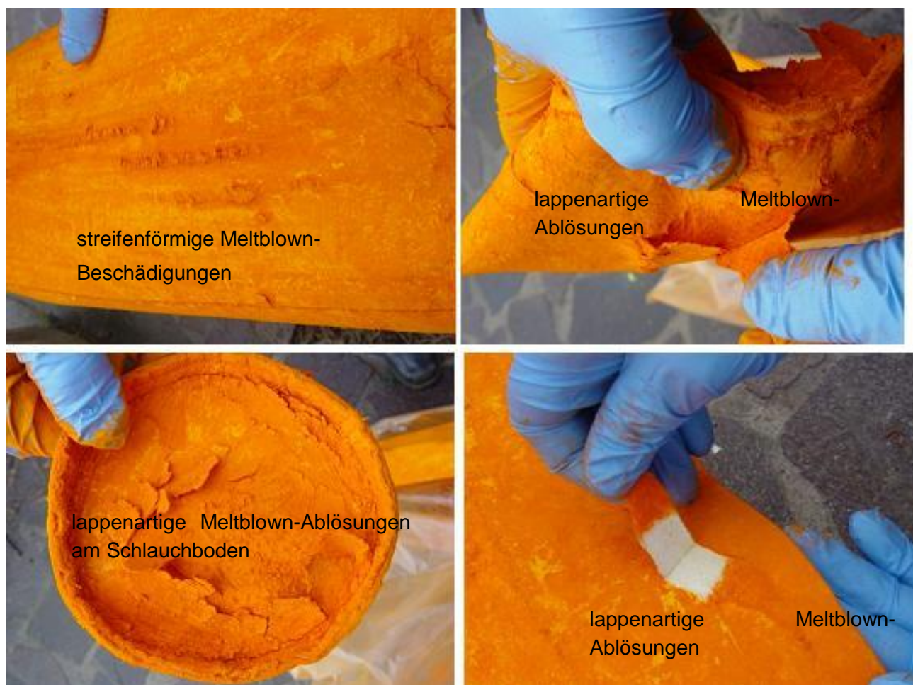
Abbildung 36: Beschädigungen der Testschläuche
