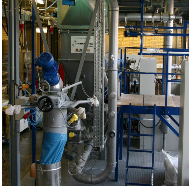
Abbildung 1: Aufgebaute Mehrschlauch-Laboranlage im Technikum des MVM vor Inbetriebnahme
