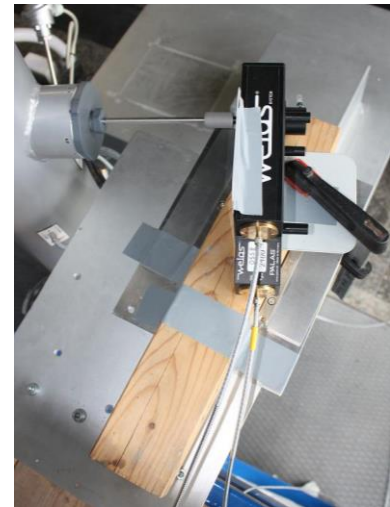
Abbildung 12: Messstelle für die Emissionsmessungen in der MSLA Links: Fließbild mit Messstellen Rechts: Foto des Sensorkopfe an Einbaustelle
