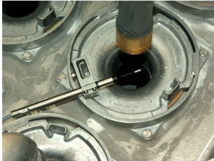
Abbildung 5: Einbauposition des Thermosensors SS20.500 über dem Filterschlauch in der Mehrschlauchlaboranlage
