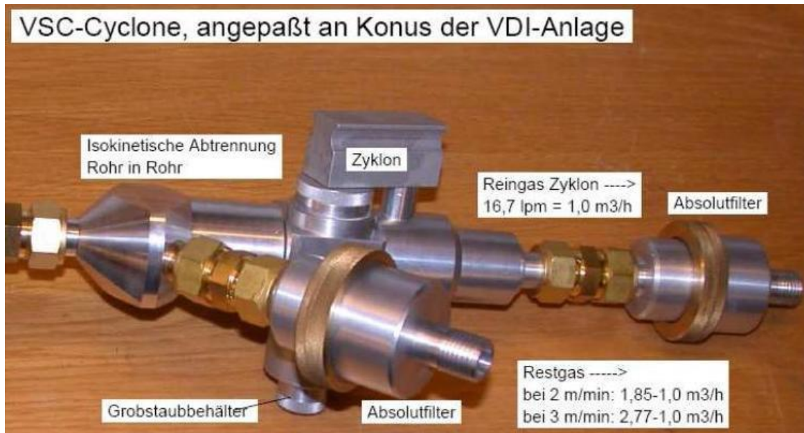
Abbildung 30: Messgerät zur gravimetrischen Bestimmung von PM 2,5 : Zyklon PM 2,5
