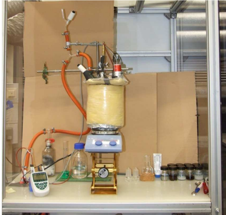
Abbildung 4.2 - Versuchsaufbau der Dampfdruckmessung
