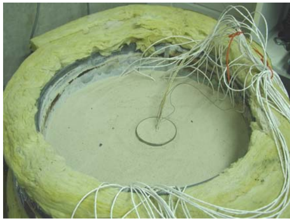
Abbildung 4: Befüllen eines Tonnenversuchsstandes
