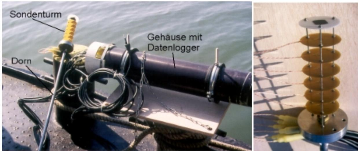
Abb. 3.28: HDS-Paket. Links (A) Gesamtpaket mit Sondenturm und Datenerfassung, rechts (B) Detailansicht des Heißfilm-Sondenturms.
