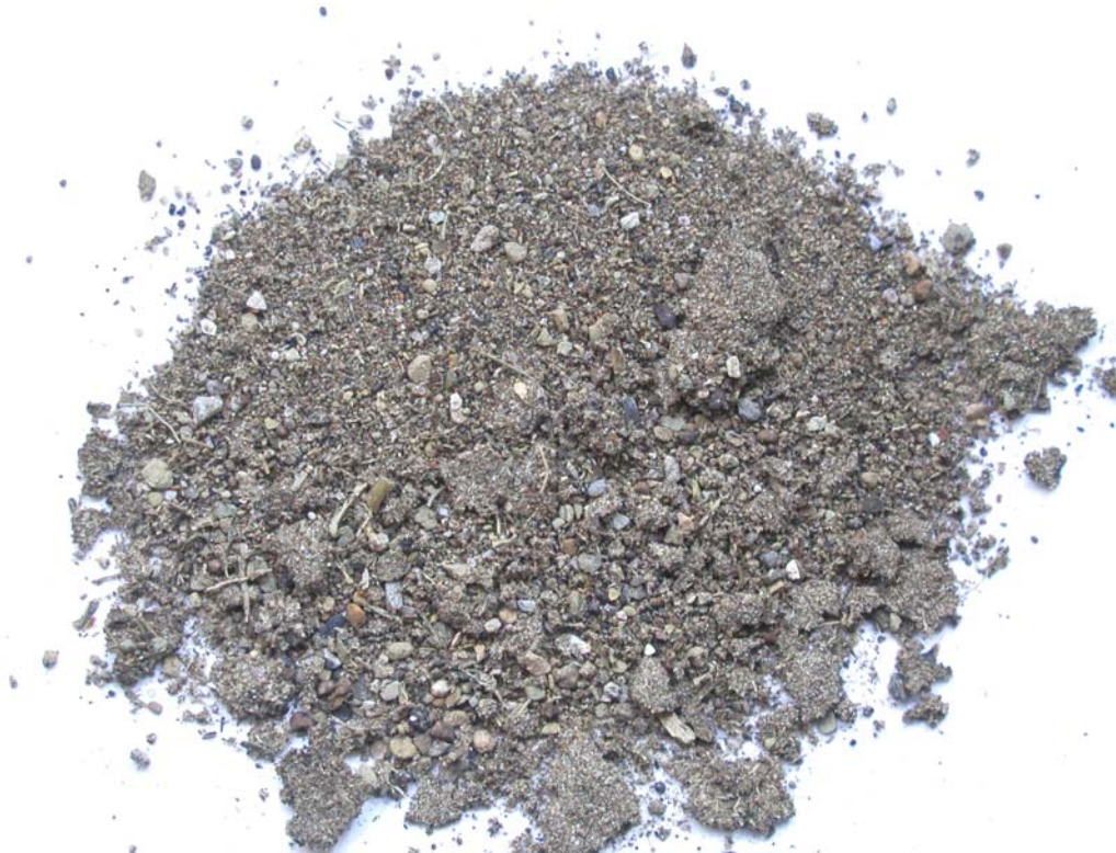
Abb. 3-13: „Sandfraktion“ einer Oberbodenprobe Es ist deutlich zu erkennen, dass neben den mineralischen Sandpartikeln auch zerkleinertes organisches Material Bestandteil dieser „Sand“-Fraktion ist.
