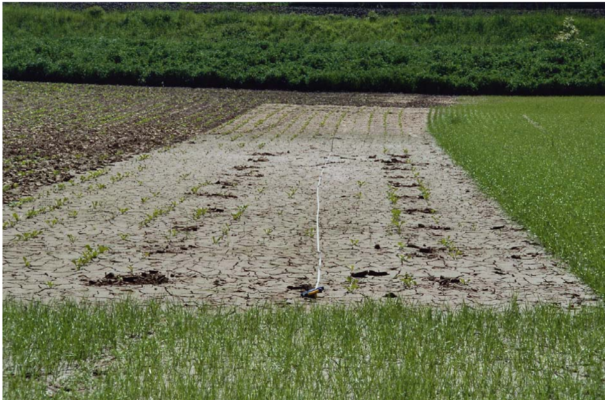
Abb. 3-5: Sedimentschichtbeprobung im Stauraum des HRB Grombach, bei dem die Sedimentschicht eines einzelnen Hochwasserereignisses beprobt werden konnte
