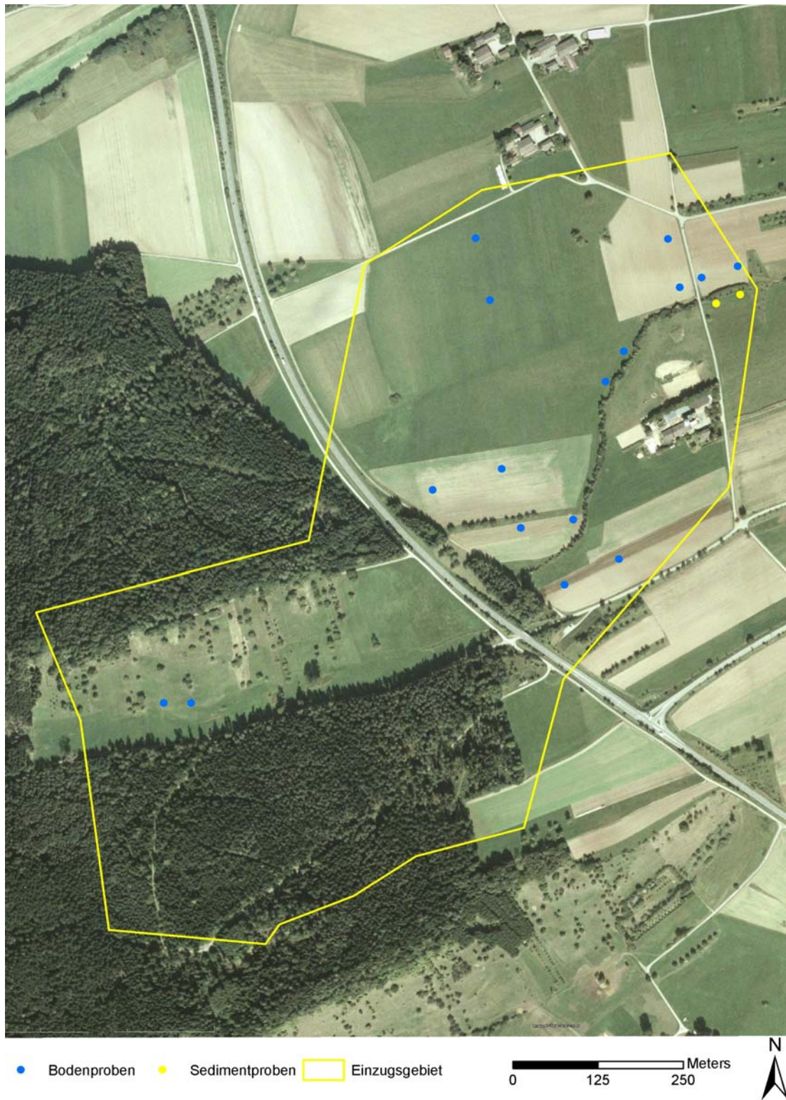
Abb. B.37: Einzugsgebiet des HRB Haigerloch mit den Standorten der Boden- (blaue Punkte) und Sedimentprobenahmestellen (gelbe Punkte).
