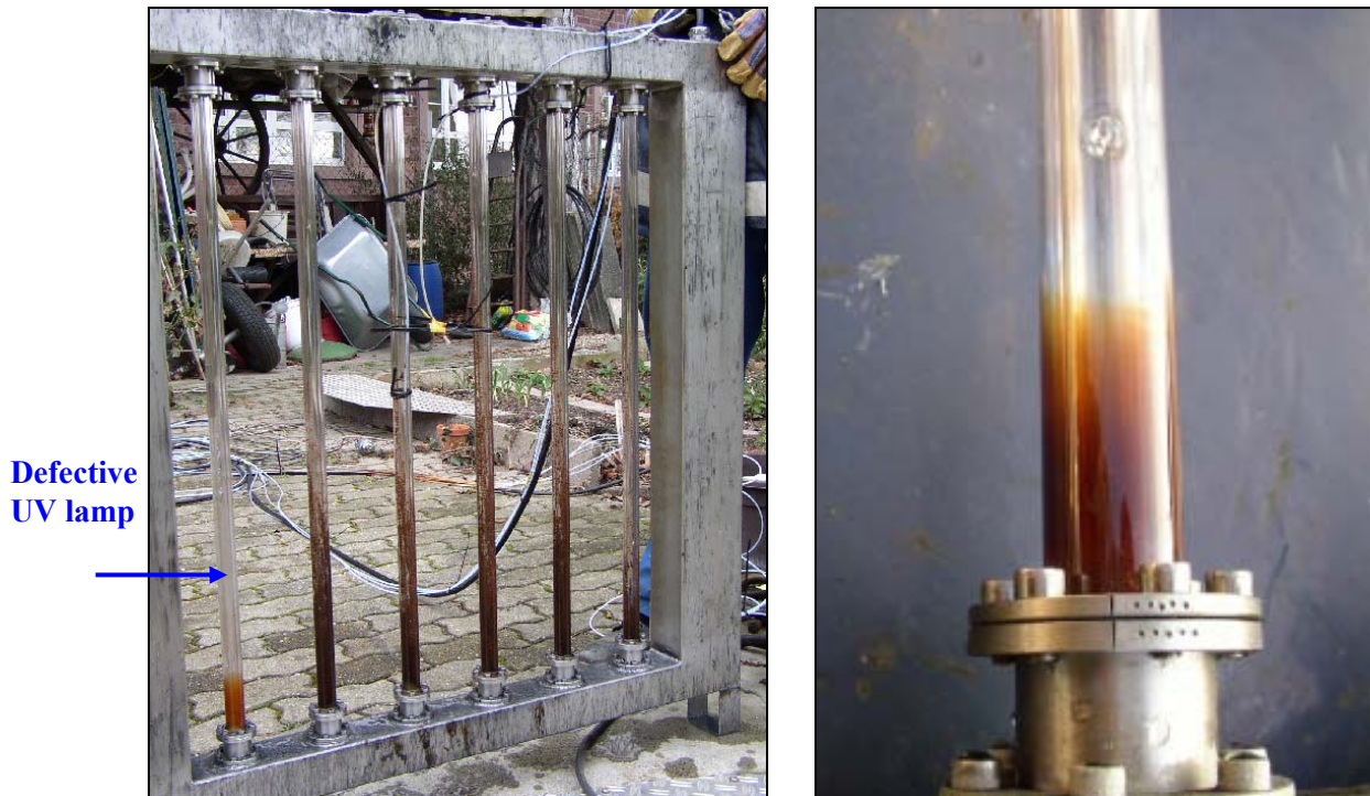
Abbildung 3-5 UV-Bestrahlungsmodul nach sechs Monaten Betriebszeit
